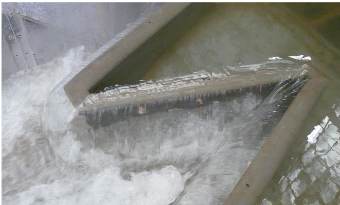
Hidraulički model lavirint preлива u Institutu za vodoprivredu „Jaroslav Černi“.
