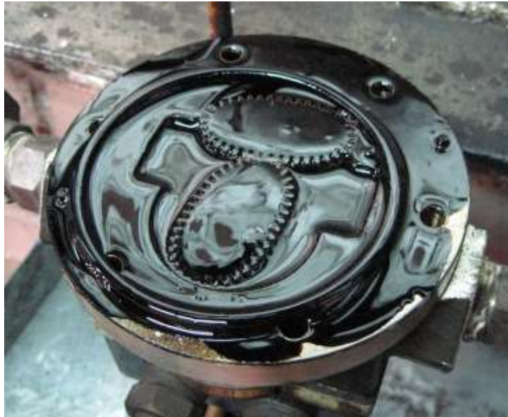
Слика 10. Механички механизам водомера, принцип рада (PD)
