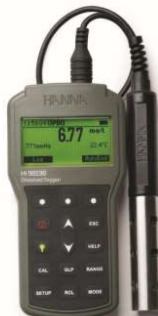
Slika 8 Optički merač rastvorenog kiseonika proizvođača Hanna
