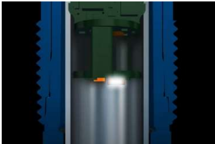
Slika 5 Presek uređaja koji radi na optičkom principu (Luminescence Quenching Method)
