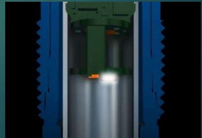
Presek uređaja koji radi na optičkom principu (Luminescence Quenching Method)
