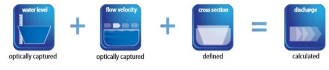
Slika 13: Princip po kojem radi DischargeKeeper uređaj
