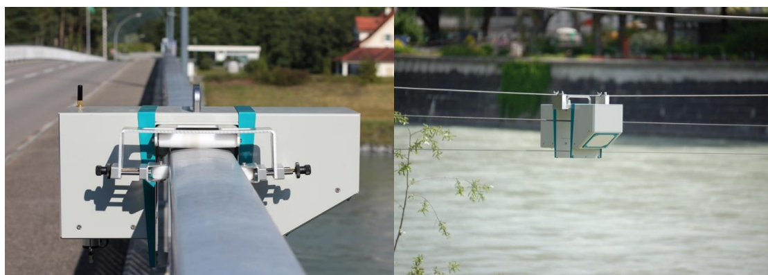
Slika 2: Dva primera mobilnog radara za merenje površinske brzine vode na otvorenom vodotoku (pomeranjem radara preko celog preseka omogućeno je snimanje površinskih brzina u celom poprečnom preseku)
