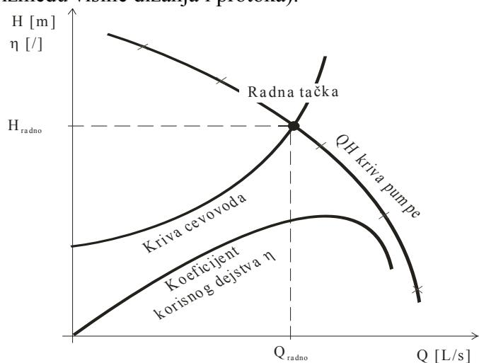
Način određivanja visine dizanja pumpe pri određenom protoku zavisi od karakteristika cevovoda od kog se sastoji laboratorijska instalacija. Ukoliko se kriva cevovoda neznatno menja pri regulaciji protoka moguće je formirati **QH** krivu na osnovu nekoliko bliskih tačaka.
