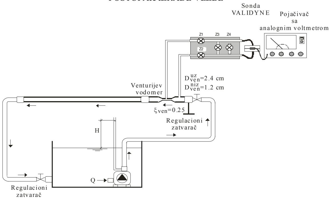
Vežba se izvodi pomoću pripremljene instalacije (vidi sliku), koja se sastoji od rezervoara u koji je potopljena pumpa, creva kroz koja teče voda, Venturijeve cevi za merenje protoka, pijezometarske cevi za merenje visine dizanja pumpe i dva voltmetra za merenje napona i jačine struje koja prolazi kroz pumpu.
