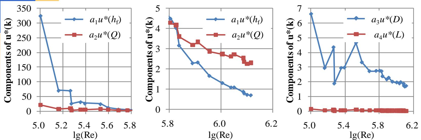
Figure 7 Effect of  $u^*(h_f)$ ,  $u^*(Q)$ ,  $u^*(D)$  and  $u^*(L)$  on  $u^*(k)$
