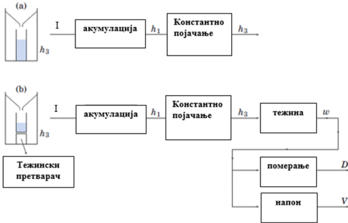
Слика 2.2. Шематски приказ других типова акумулационих кишомера
