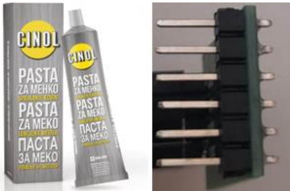
Слика 3.19. Паста за што боље пријањање калаја за плочу (лево), трајни спој на плочи појачивача (десно)
