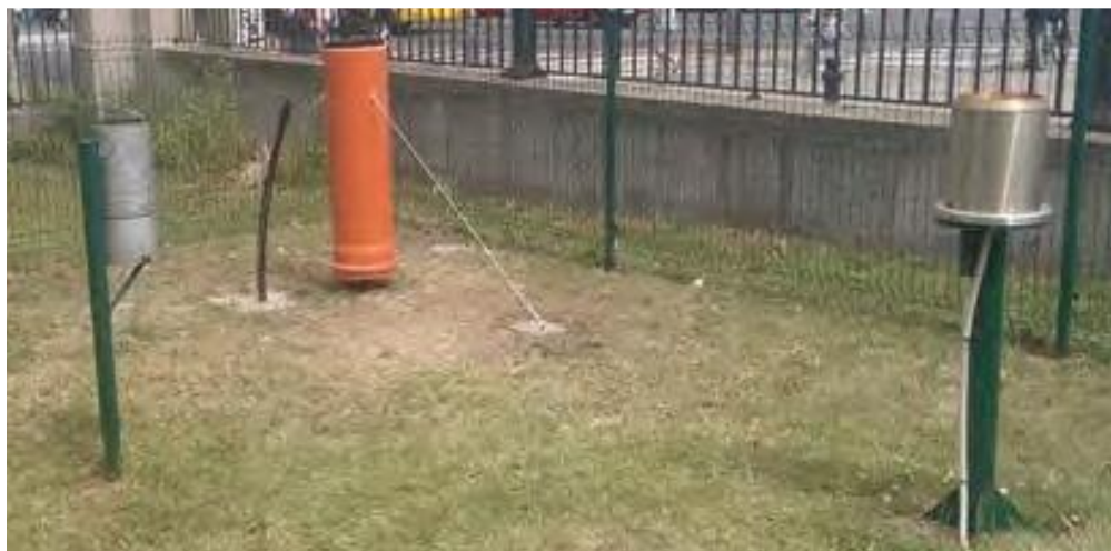
Слика 3.7. Кишомери на тежинском принципу HBM на простору метеоролошког подручја Грађевинског факултета у Београду (Д.Продановић, П.Војт и Д. Павловић 2018).
