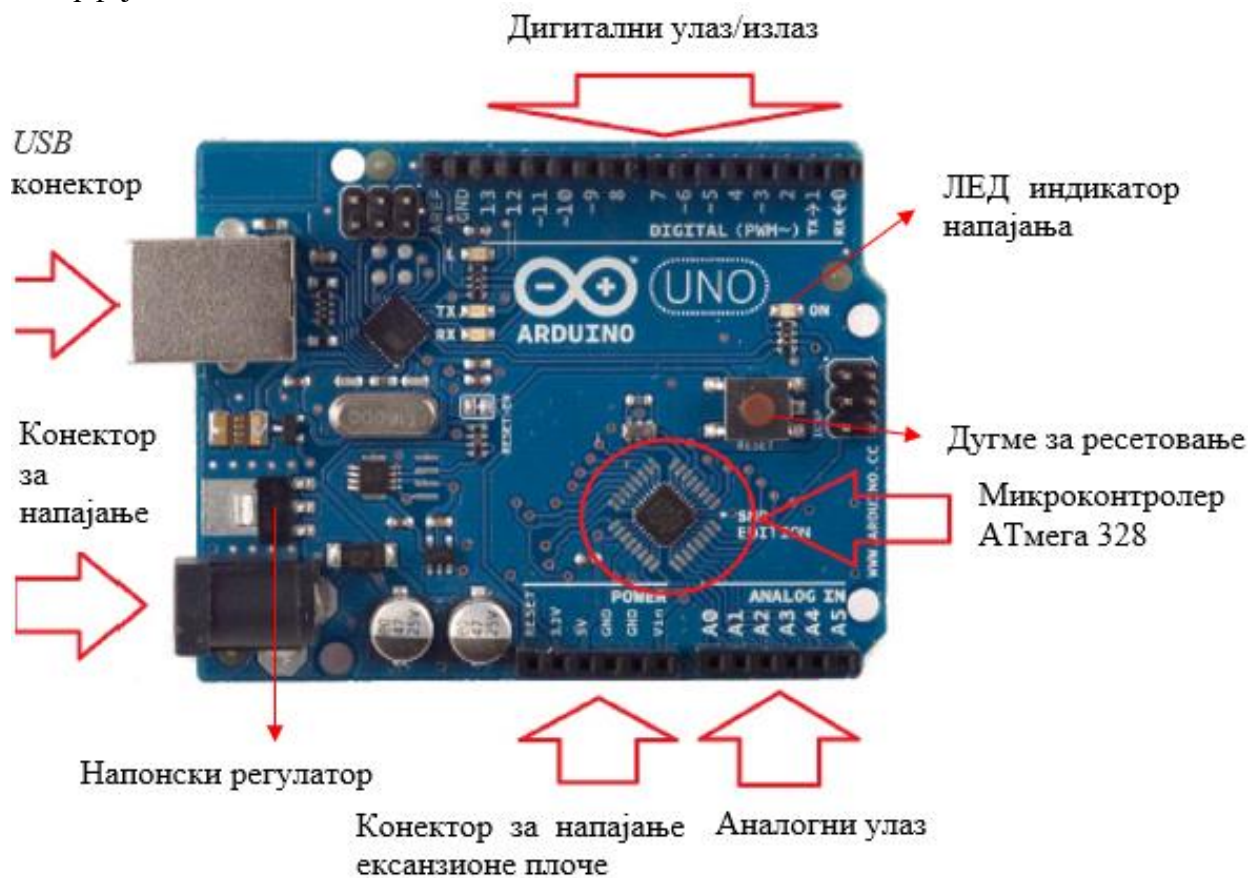
Слика 3.12. Изглед и распоред основен плоче АрдуиноУно система
