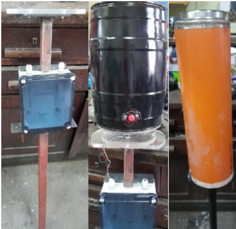
Слика 3.29. Фазе повезивања конструктивних компоненти: носач (лево), носећа плоча и чантра (средина) и оклоп са левком (десно)
