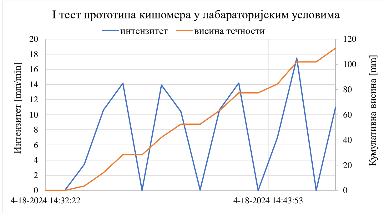
Дијаграм 5: Резултати I теста прототипа кишомера у лабораторијским условима
