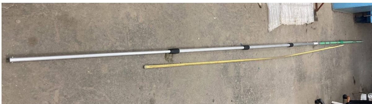
Слика 4.3.4 Развучена телескопска шипка са монтираним продужецима
