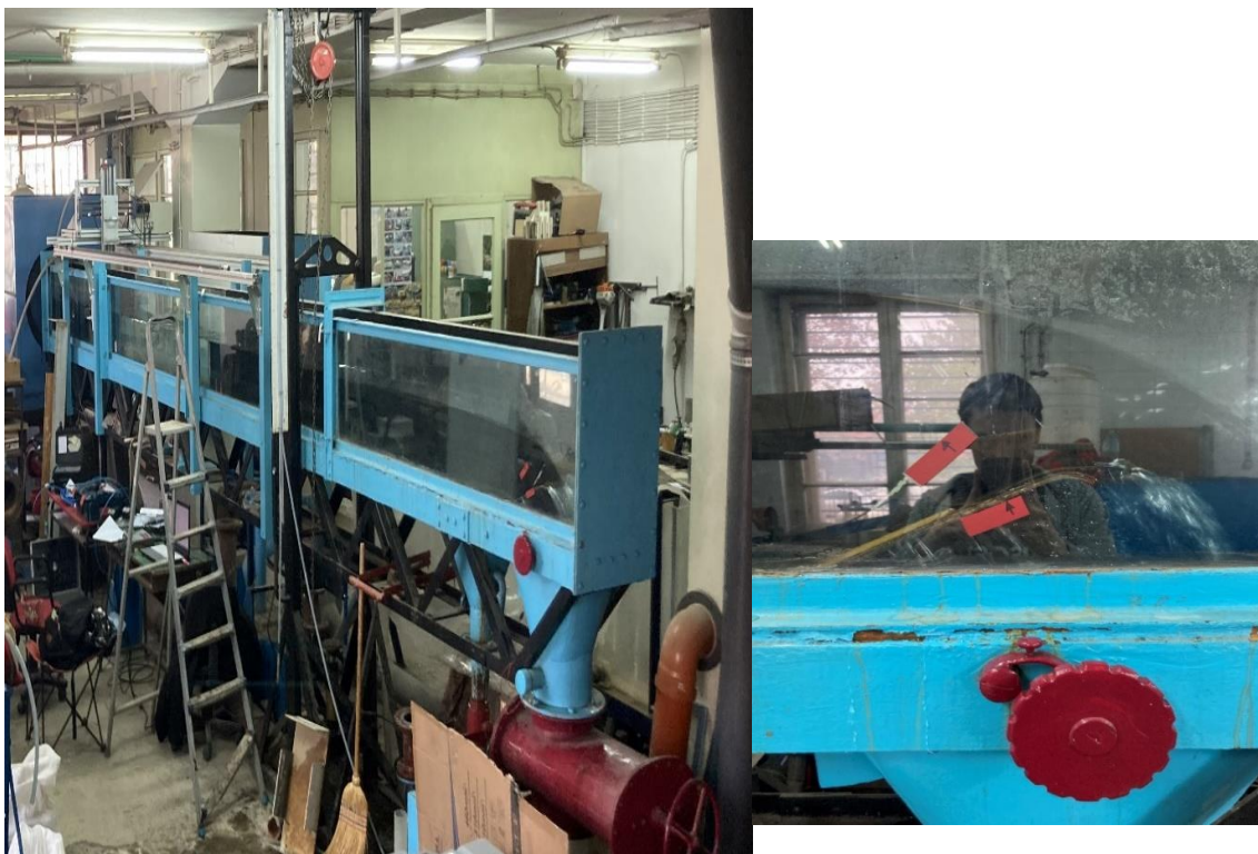
Слика 3.2.1 Лабораторијска инсталација Института за хидротехнику (лево) и устава за регулисање нивоа у лабораторијском каналу (десно)
