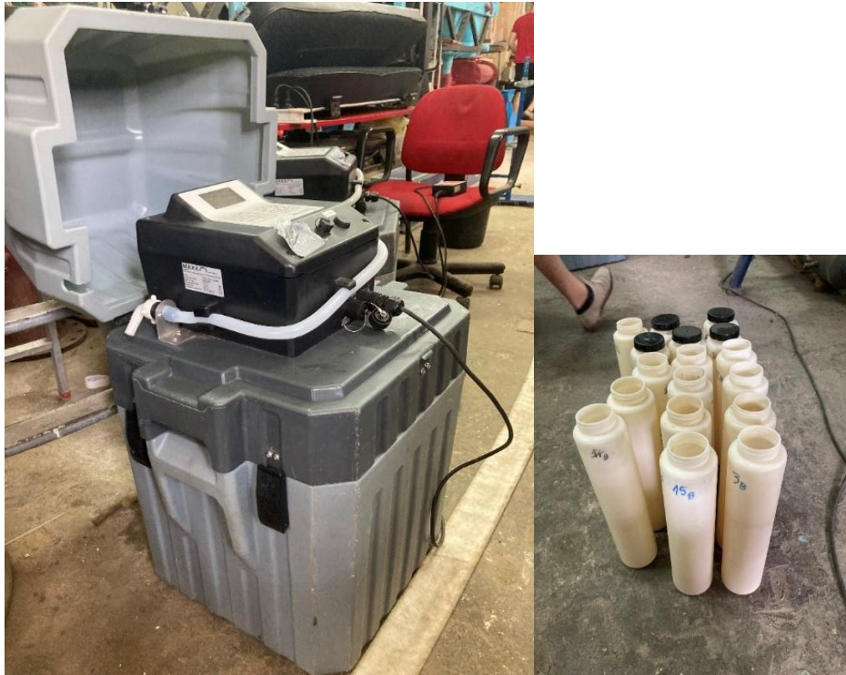
Слика 3.1.10 Узоркивач са перисталтичком пумпом "Махх - TP5 С" (лево) и боце за складиштење узорака запремине 1 L (десно)
