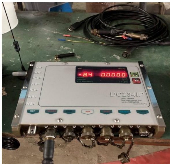
Слика 3.1.1 Програмабилни контролер DC234 са каблом за конекцију и антеном за даљинску комуникацију
