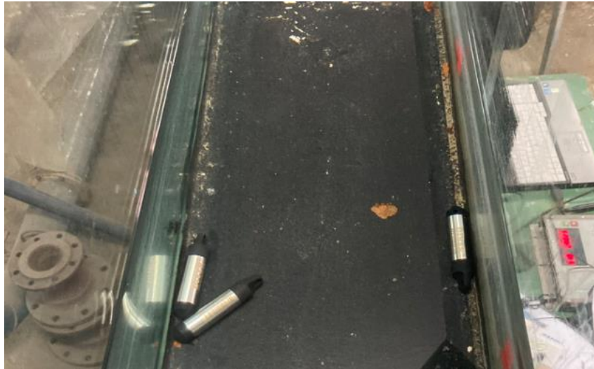
Слика 3.2.2 Распоред дајвера у лабораторијском каналу за време испитивања
