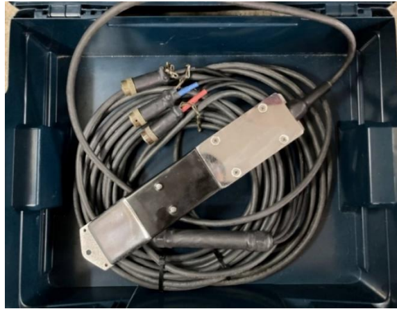
Слика 3.1.2 EM сонда – Flat compact model S са каблом за конекцију
