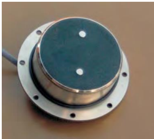
Слика 3.1.4 EM сонда – модел Flat 100
