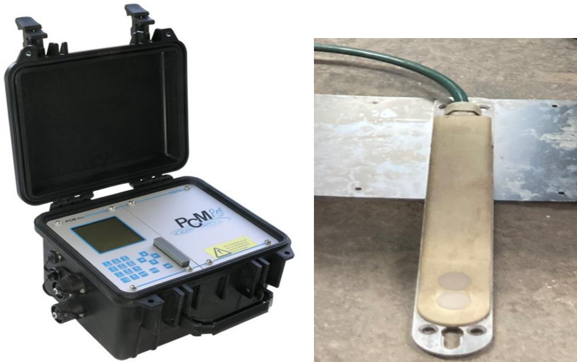
Слика 3.1.5 Рачунска јединица УЗВ протокомера - Nivus PCM Pro (лево) и крос-корелациона УЗВ сонда (десно)
