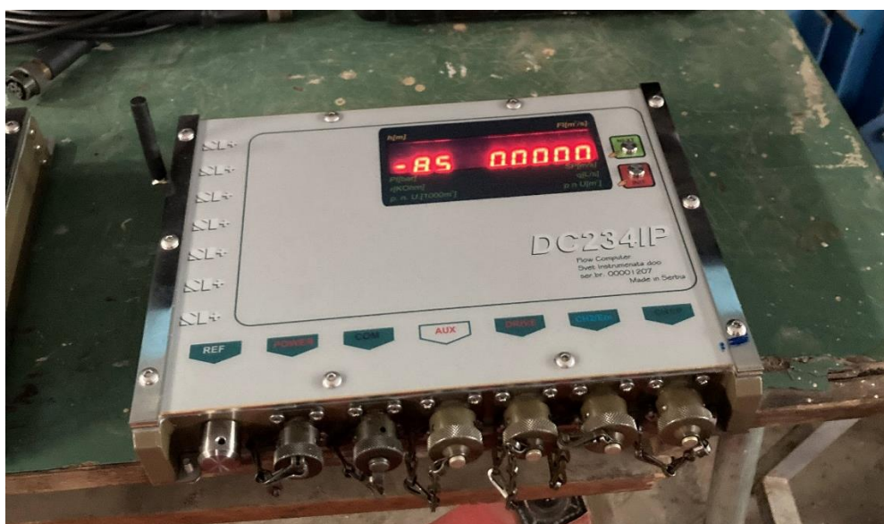
Слика 4.3.5 Контролер DC234 са стандардном антеном за даљинску комуникацију
