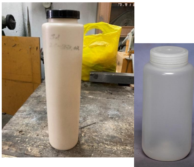
Слика 2.3.3 Боце за захватање појединачних узорака отпадне воде запремине 1000 ml
