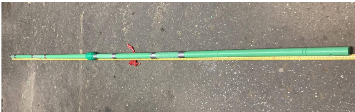
Слика 4.3.3 Спојени сегменти за продужетак телескопа
