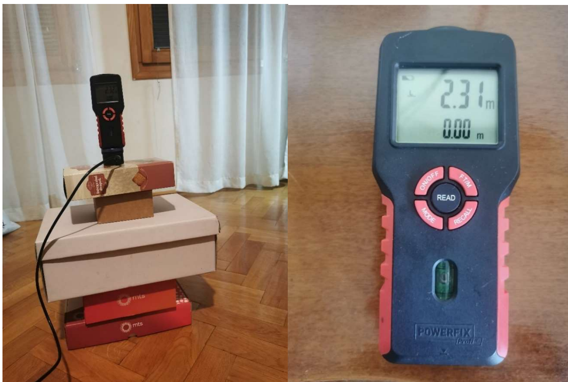
Слика 21: Илустрација експеримента мерења у ваздуху и приказ ласерског даљинометра
