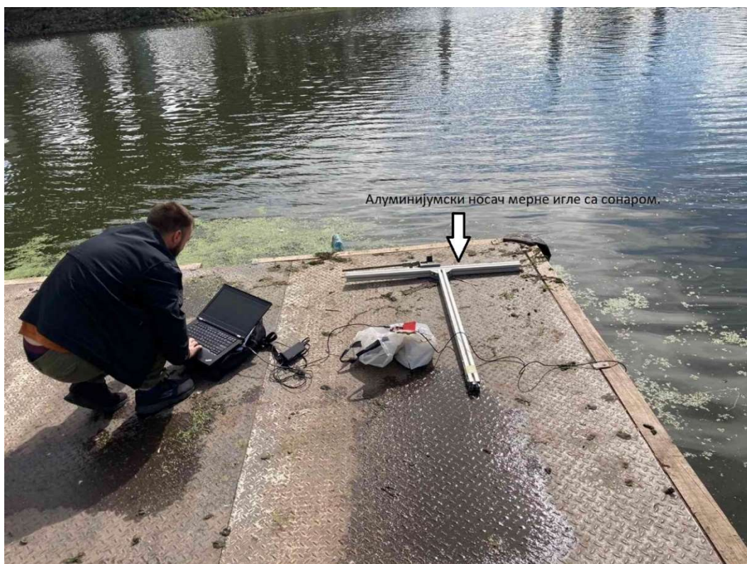
Слика 24: Припрема опреме за мерења. На слици се може уочити алуминијумски носач мерне игле са сонаром. Носач је конструисан тако да би се превазишла денивелација између коте површине воденог огледала и коте на сплаву.
