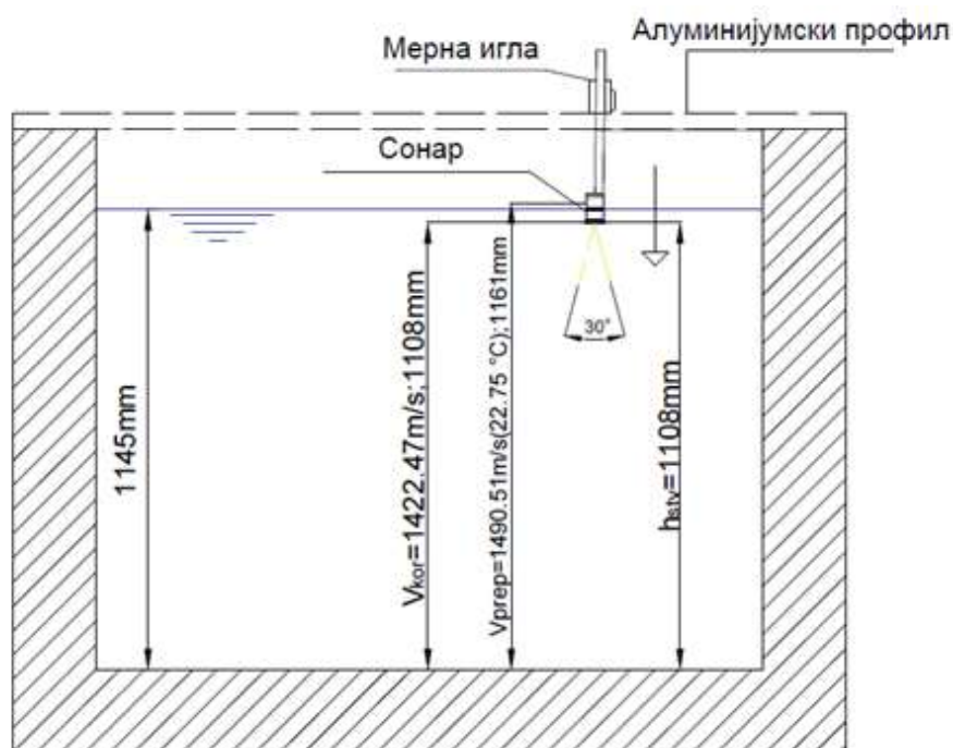
Слика 19: Илустрација изведеног мерења на каналу Института за хидротехнику, корекција препоручене брзине на брзину која одговара стварној дубини. Мерење се одвија померањем ка дну.
