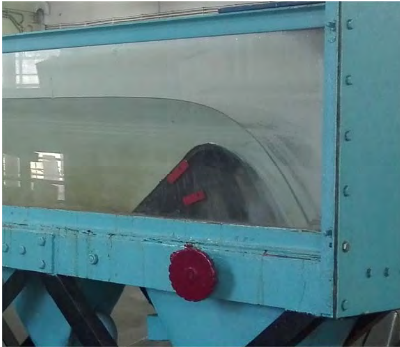
Слика 3.6: Устава постављена у великом лабораторијском каналу
