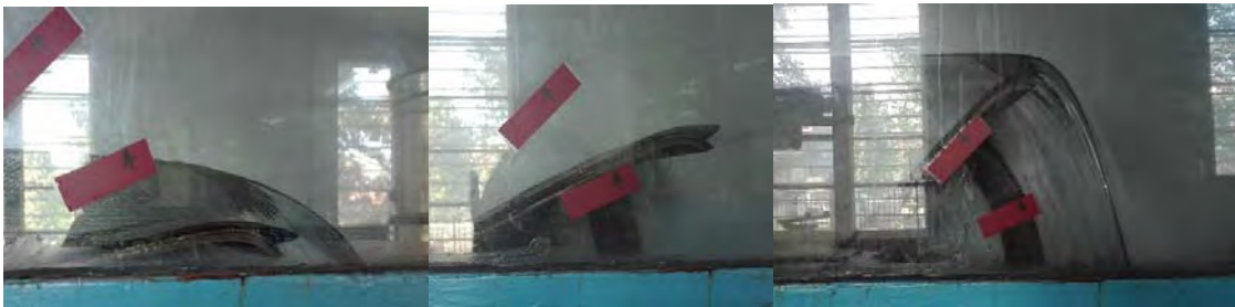
Слика 3.10: Три различита положаја уставе; слева: најнижи (VK1), средњи (VK2) и највиши (VK3)
