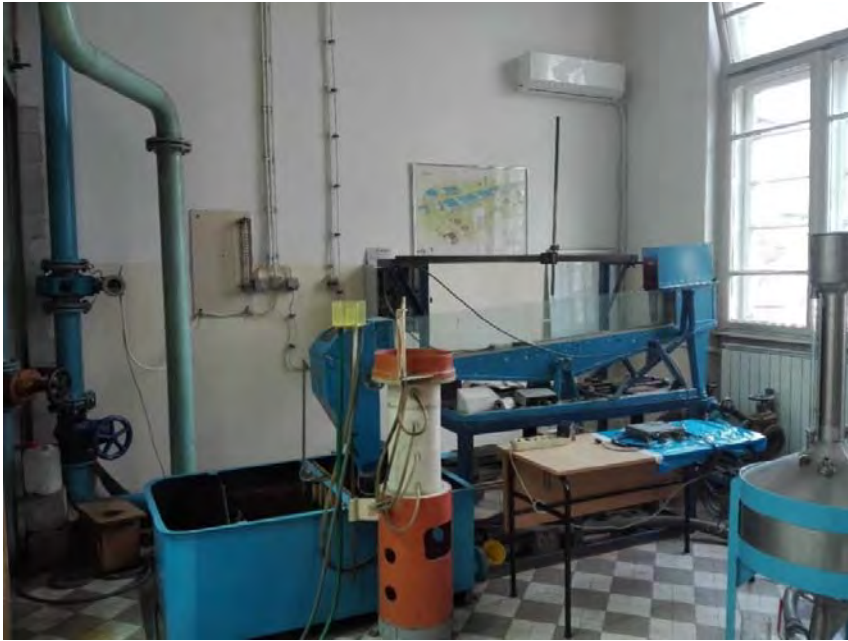
Слика 3.7: Лабораторијска инсталација – мали канал (МК) у учионици Института за хидротехнику и водно – еколошко инжењерство
