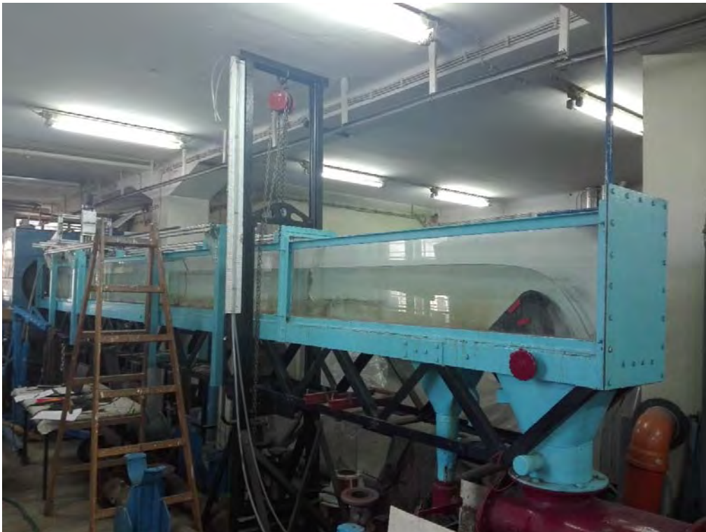
Слика 3.2: Лабораторијска инсталација – велики канал у лабораторији Института за хидротехнику и водно – еколошко инжењерство Грађевинског факултета у Београду
