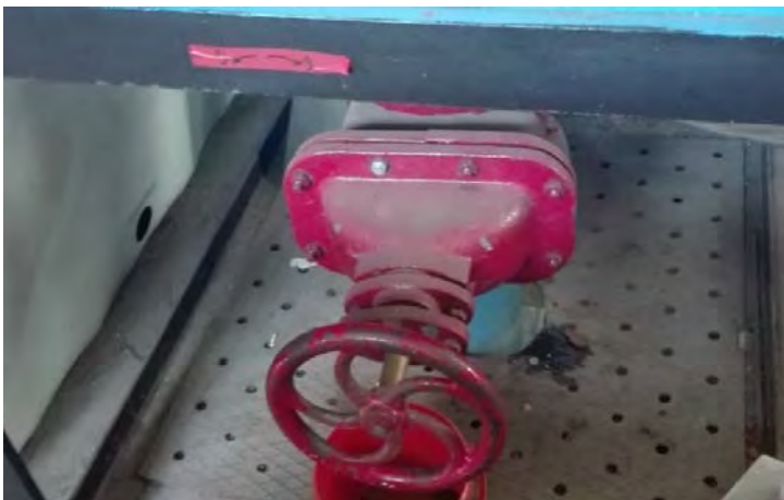
Слика 3.5: Табласти затварач за регулацију протока кроз лабораторијски канал
