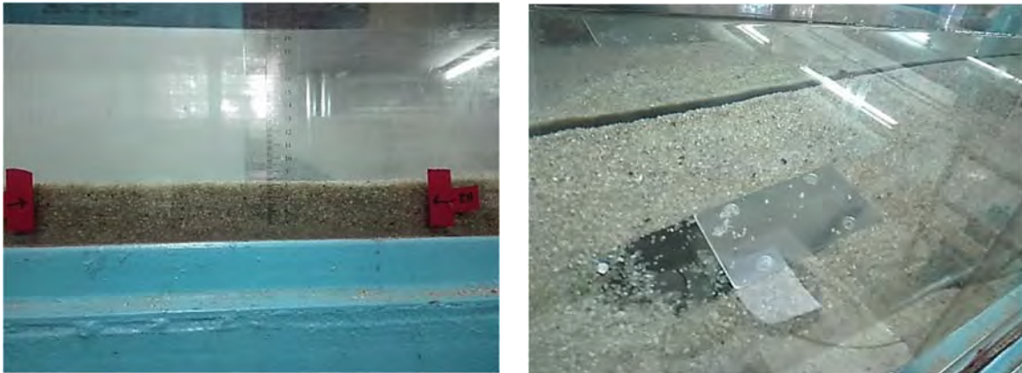
Слика 3.13: Лево – сонда под слојем седимента од 80 mm; десно – сонда под слојем седимента од 35 mm
