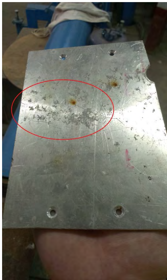
Слика 16. Фотографија глатке еталне плоче са обележеном задрљаном зоном
