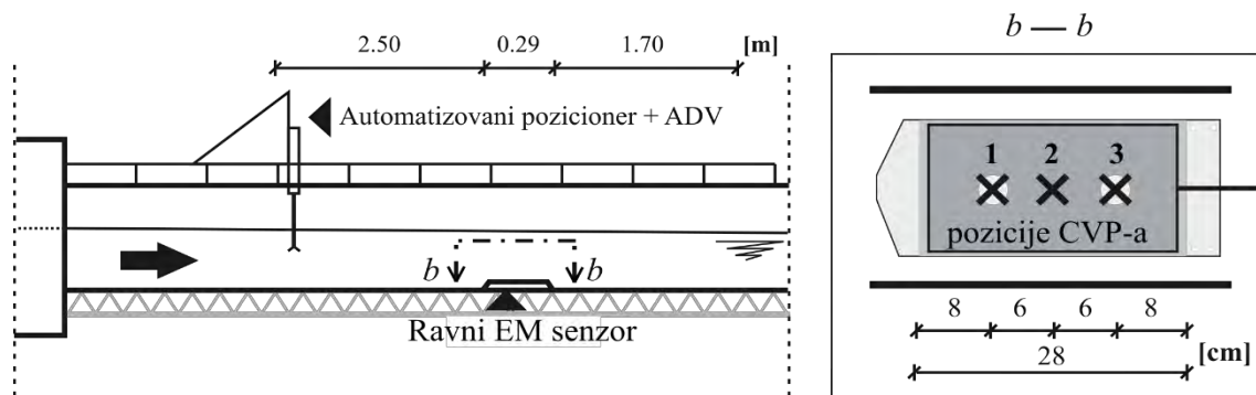
Слика 18. Шематски приказ положаја Централних вертикалних профила изнад ЕМ сензора, коришћених за мерење подужне компоненте брзине помоћу АДА сензора (Иветић, 2019)
