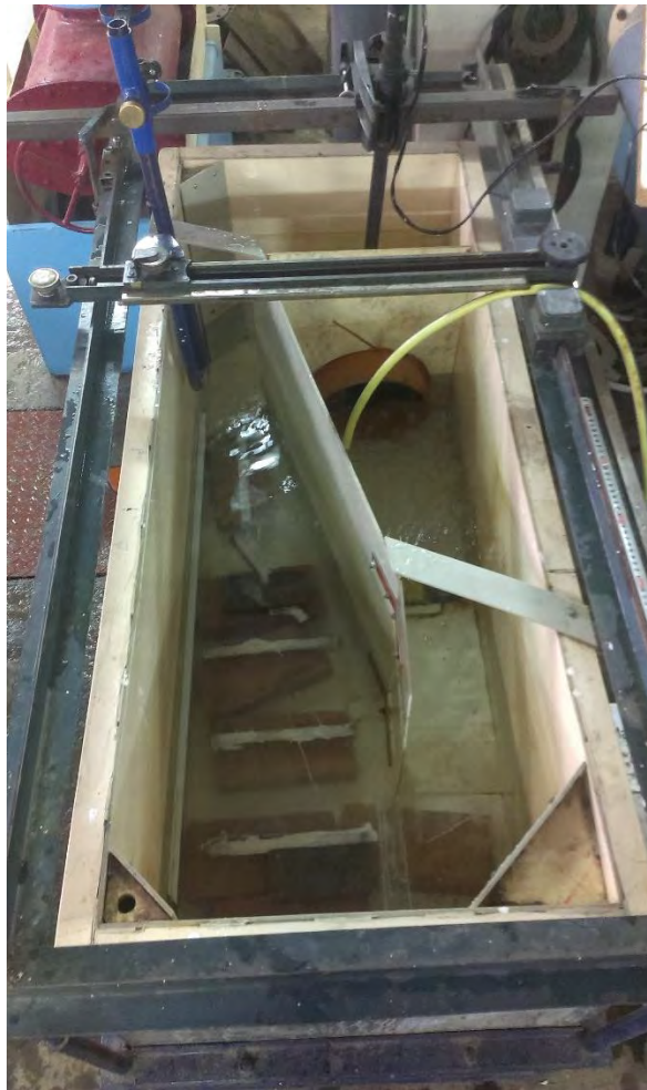
Слика 4. Фотографија рециркулационог резервоара током пуњења водом
