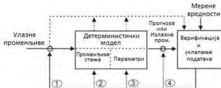
Слика 1.1 Различити нивои уклапања података у модел (1) Уклапањем улазних података (2) Уклапањем променљивих стања (3) Одређивањем параметара модела (калибрација) (4) Корекцијом излазних променљивих [1]
