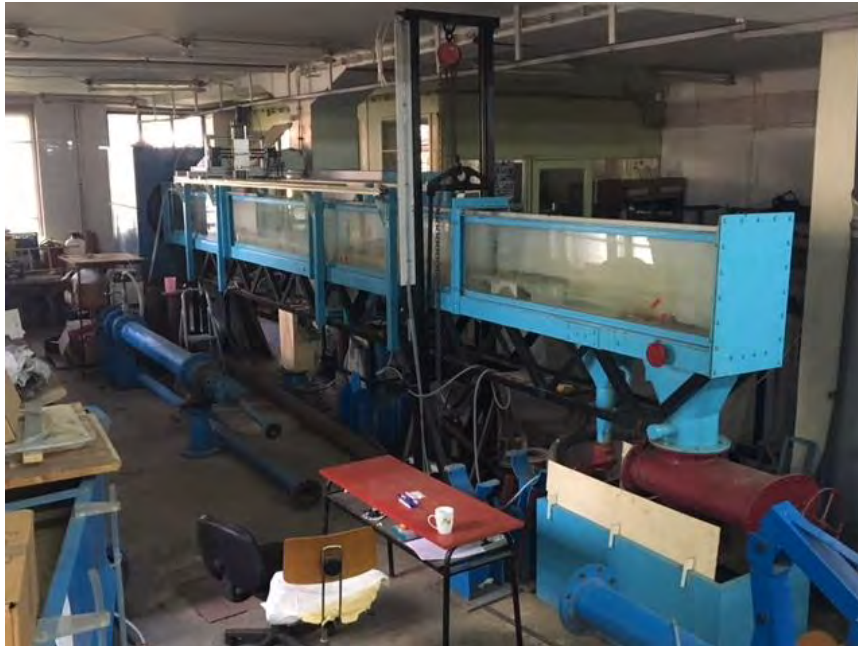
Slika 3.9 Fotografija laboratorijske instalacije u prizemlju hidrauličke laboratorije, Građevinskog fakulteta, Univerziteta u Beogradu, korišćene za ispitivanje rada Ravnih EM senzora.
