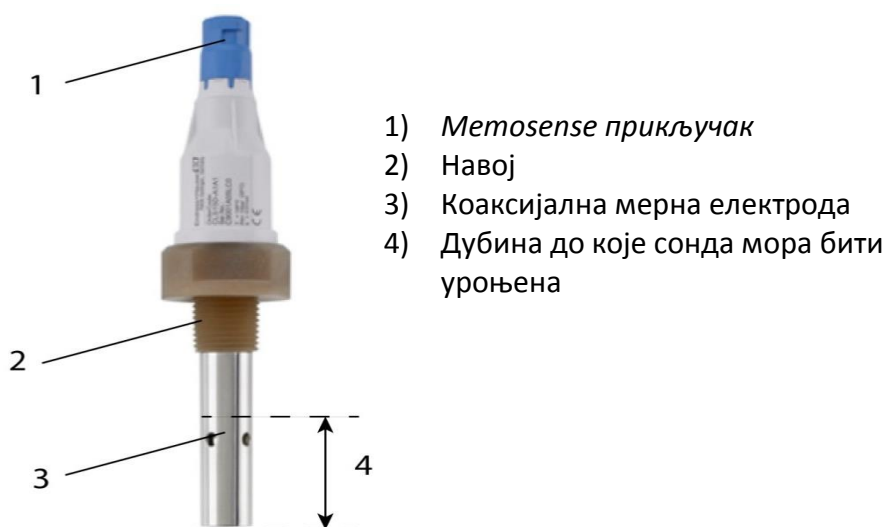
Слика 8. Сонда за мерење електропроводљивости и делови сонде
