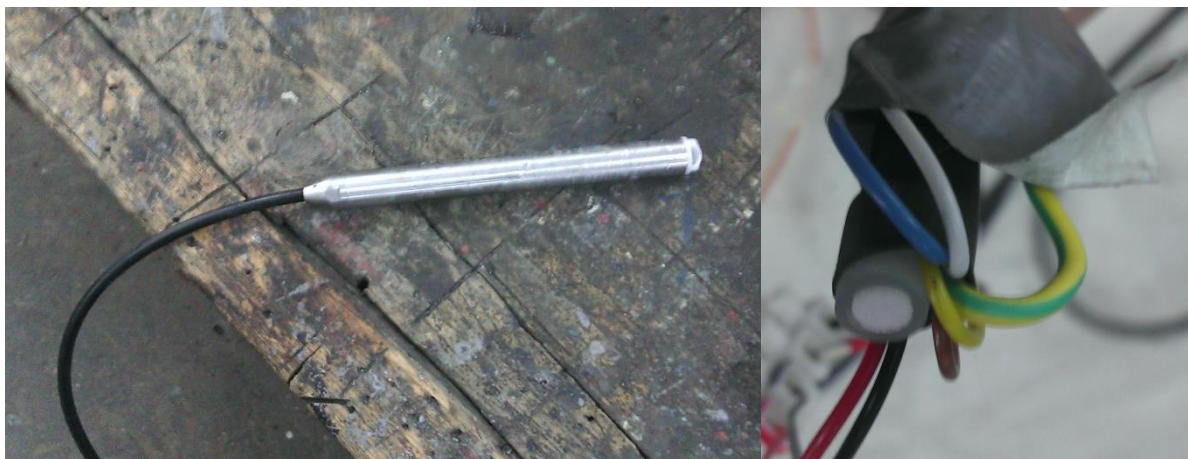
Слика 15. Сонда за мерење нивоа преко хидростатичког притиска и елемент за компензацију притиска
