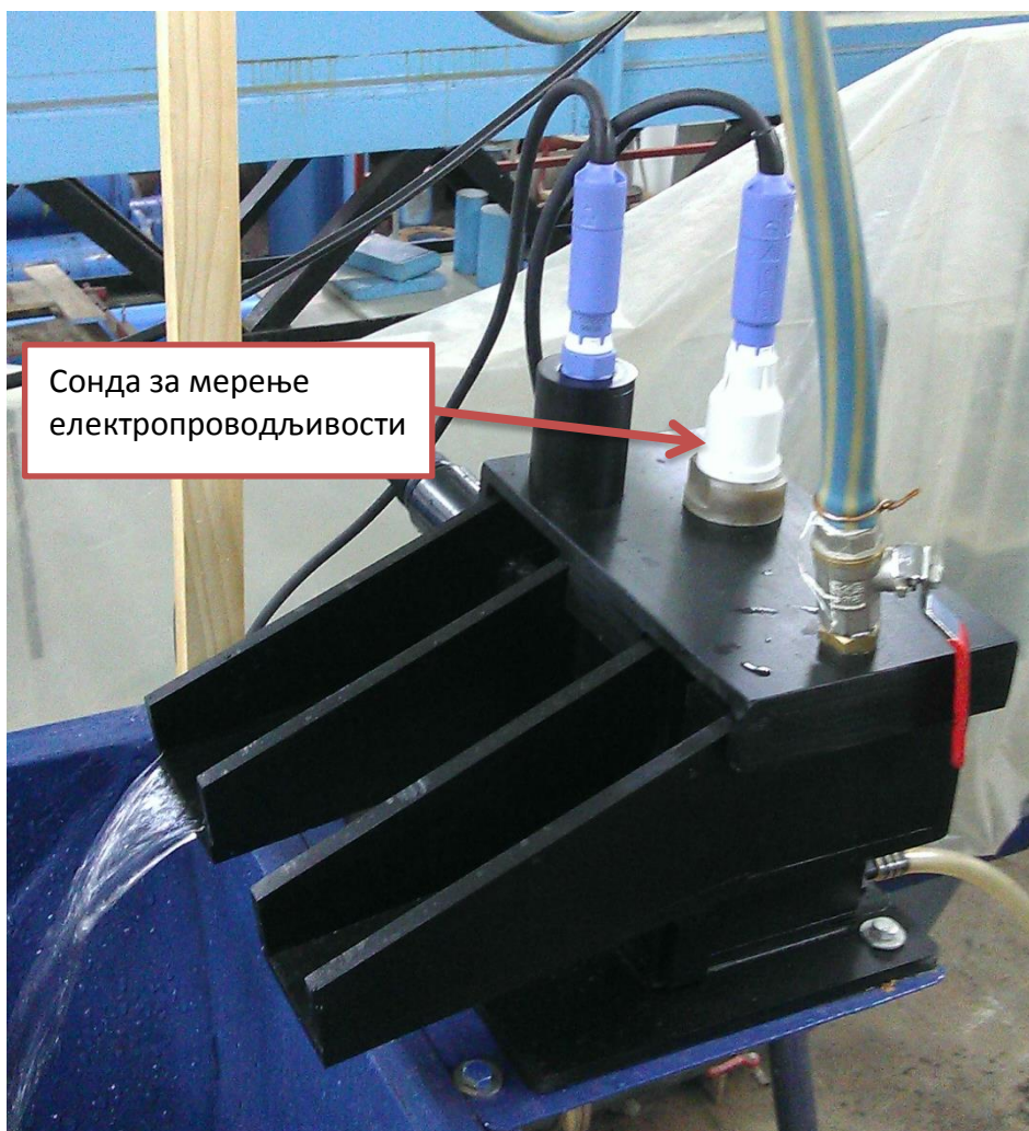
Слика 31. Положај сонде за мерење електропроводљивости у мерној кутији
