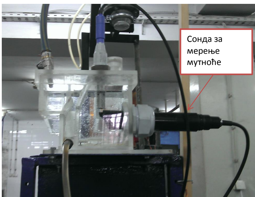
Слика 34. Положај сонде за мерење мутноће у мерној кутији
