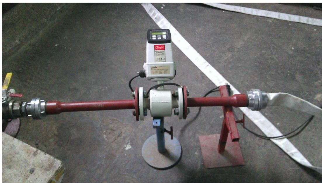
Слика 26. Електромагнетни мерач протока на ватрогасном цреву
