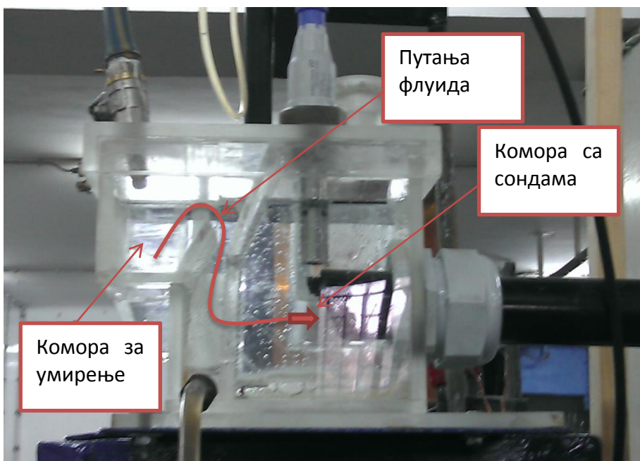
Слика 36. Приказ путање флуида кроз мерну кутију
