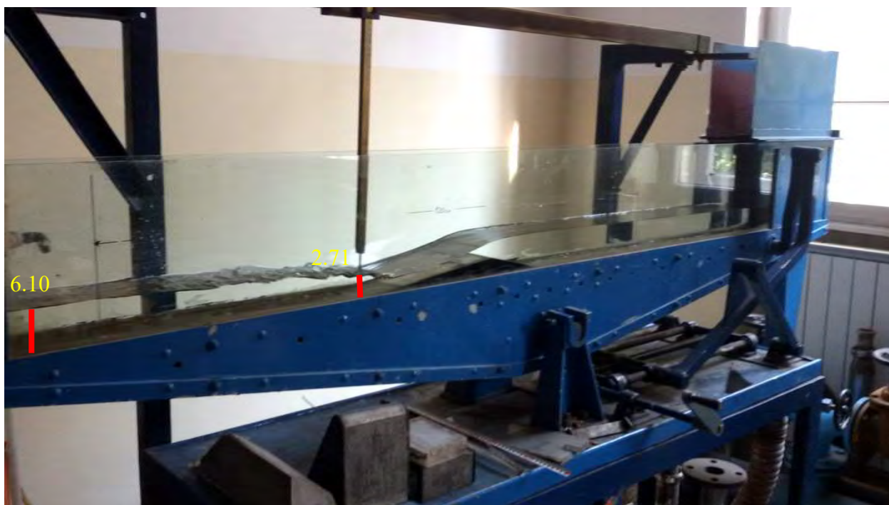
Slika 68.4. Slučaj – sa drugim hidrauličkom skokom, H_{niz} = 6.1\text{cm}
