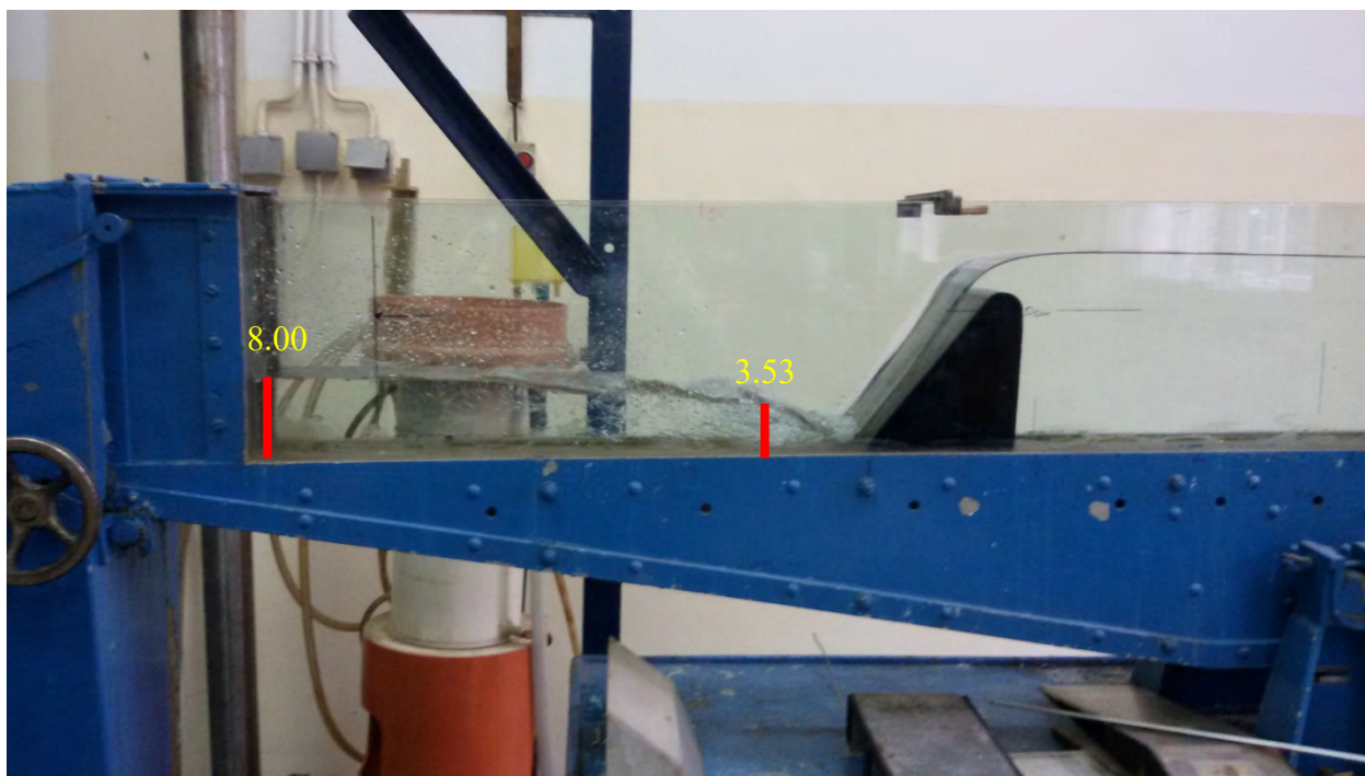
Slika 60. 2. Slučaj – sa drugim hidrauličkom skokom, H_{niz} = 8\text{cm}
