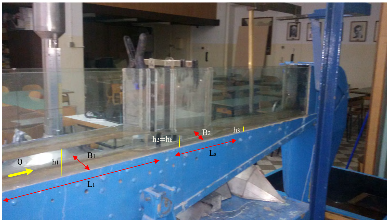
Slika 61. Kanal sa mernim suženjem trapeznog poprečnog preseka
