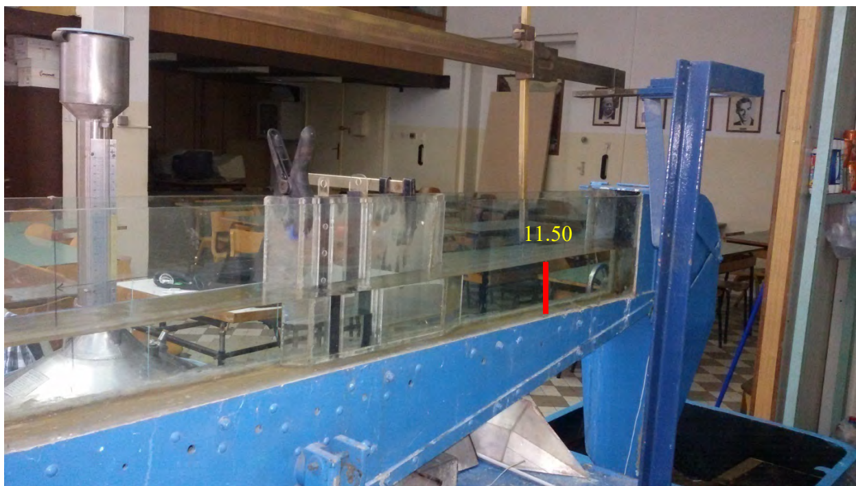
Slika 65. 3. Slučaj – potopljeno suženje, H_{niz} = 11.5\text{cm}
