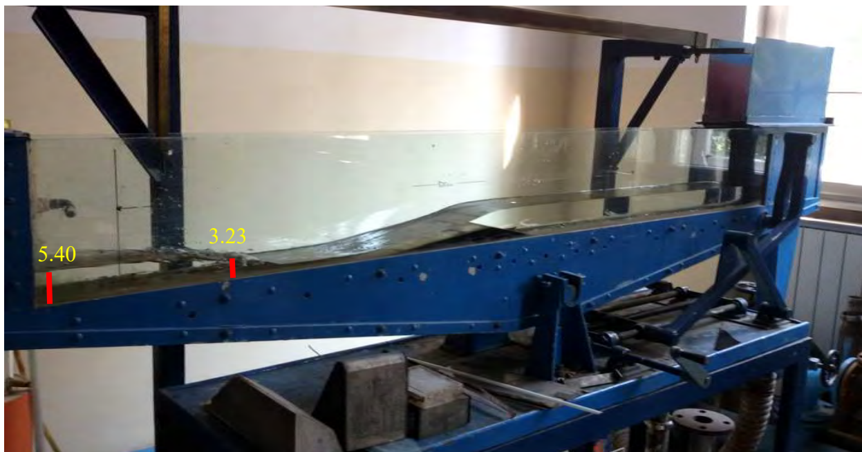
Slika 67. 4. Slučaj – sa prvim hidrauličkom skokom, H_{niz} = 5.4\text{cm}
