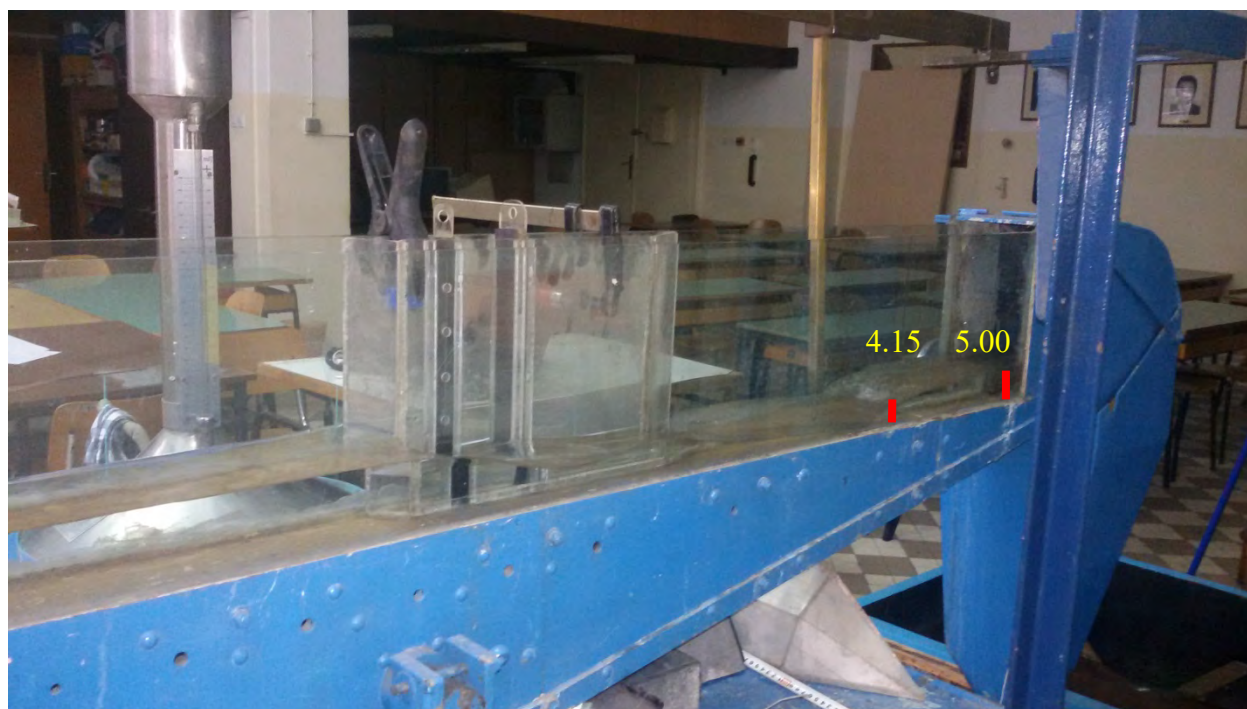
Slika 63. 3. Slučaj – sa prvim hidrauličkom skokom, H_{niz} = 5\text{cm}
