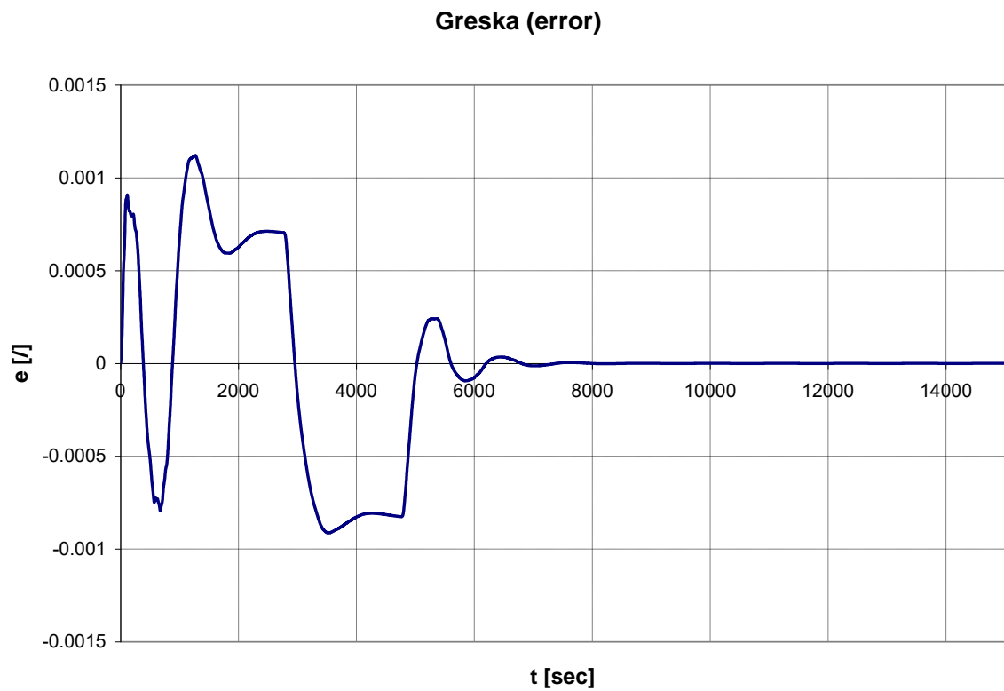
Слика 53. Грешка (error) као резултат рада PID контроле за варијанту параметара 7
