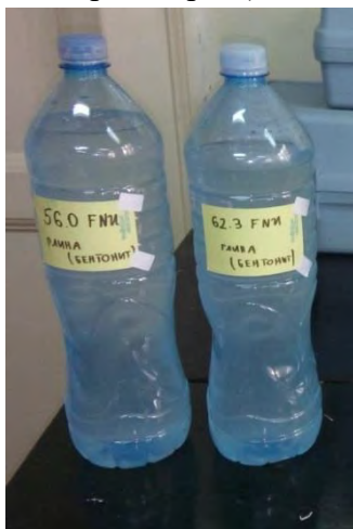
Слика 4.3.3.1: Лабораторијски узорак константне мутноће коришћен у експериментима
