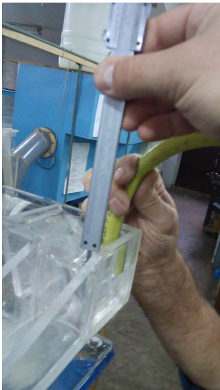
Слика 6.1.1: Пуштање протока у систем и мерење висине преливног млаза нонијусом
