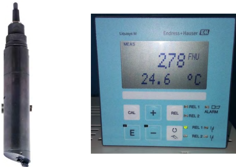
Слика 2.4.3.2: Пример коришћеног мерног система за мутноћу
