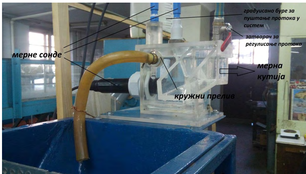
Слика 3.1: Диспозиција мерног система
