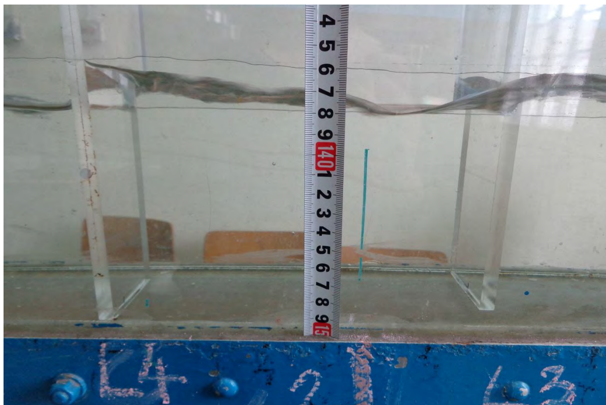
Слика Д5: Дубина воде између треће и четврте преграде на левој страни модела.
