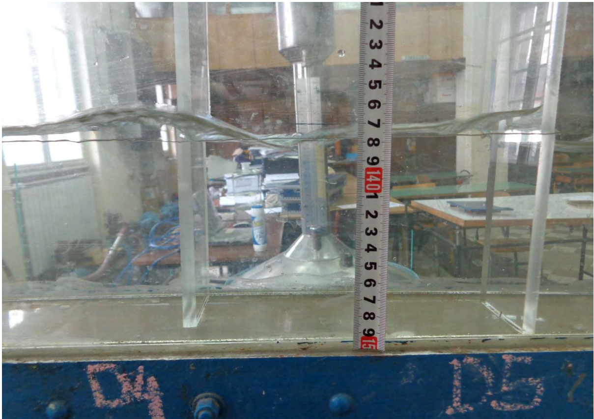
Слика Д13: Дубина воде између четврте и пете преграде на десној страни модела.
