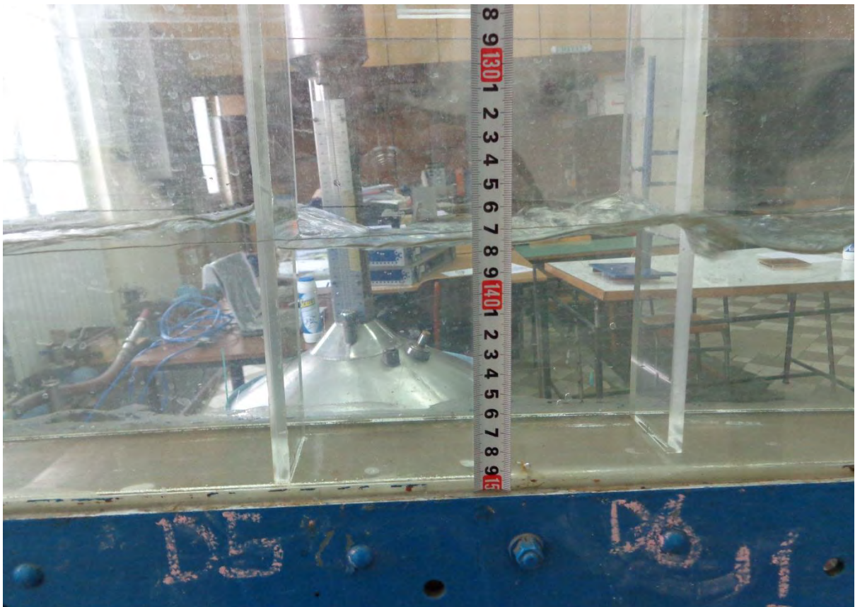
Слика Д14: Дубина воде између пете и шесте преграде на десној страни модела.
