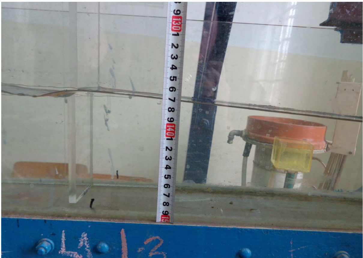
Слика Д2: Дубина воде испред прве преграде на моделу, лева страна.
