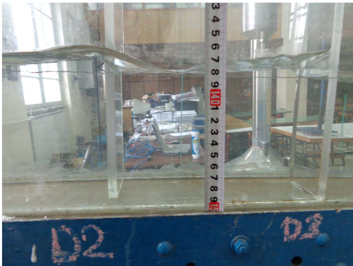
Слика Д11: Дубина воде између друге и треће преграде на десној страни модела.
