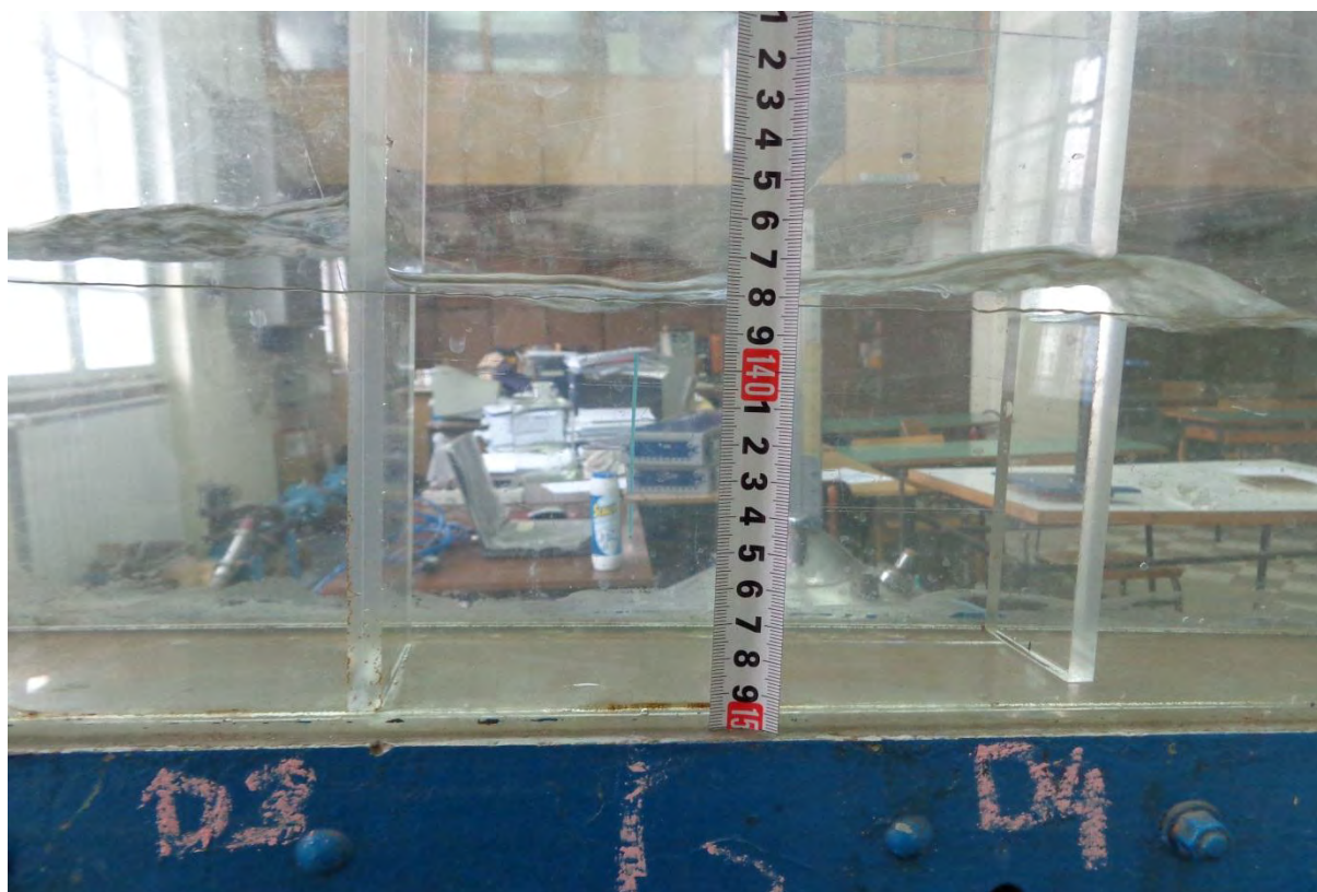
Слика Д12: Дубина воде између треће и четврте преграде на десној страни модела.
