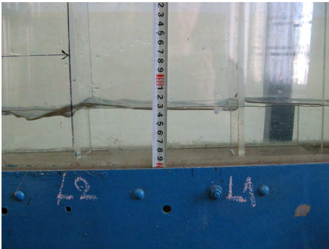
Слика 3.3.2.1: Дубина воде између прве и друге преграде на левој страни модела.
