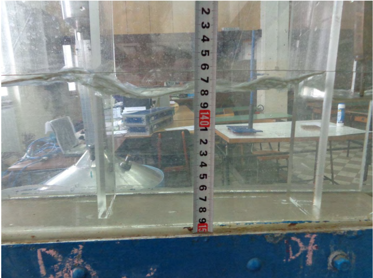
Слика Д15: Дубина воде између шесте и седме преграде на десној страни модела.
