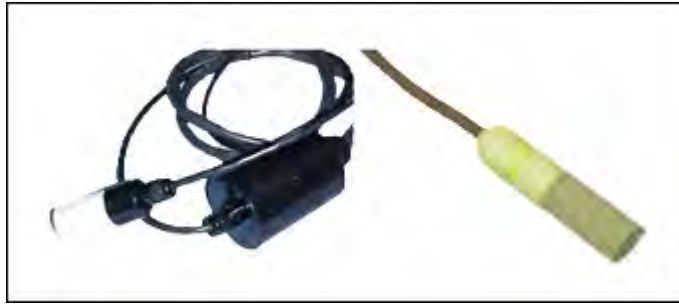
Слика 7. Сonda заснована на принципу расипања топлоте
