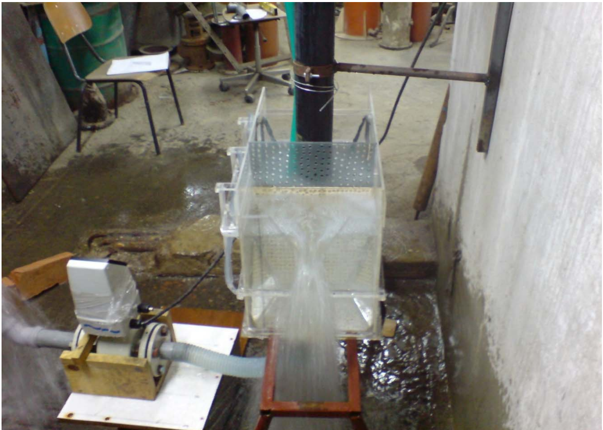
Слика 25: Мерна кутија + мерач, диспозиција 3, провера динамике система, тренутни проток кроз систем 2.8 l/s
