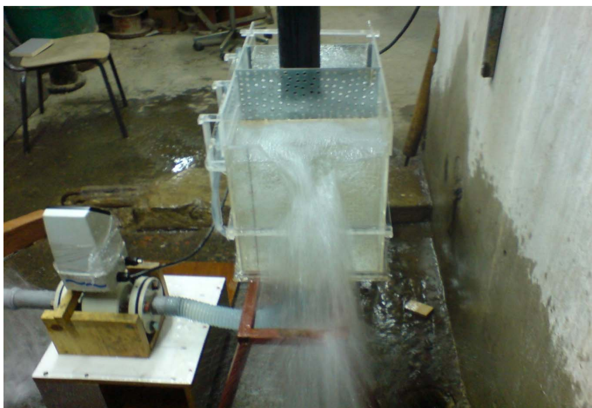
Слика 23: Мерна кутија + мерач, диспозиција 2, провера динамике система, тренутни проток кроз систем 3.5 l/s
