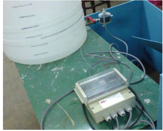
Слика 15: Мали мерач протока SI+ EM DN8 и инсталација за калибрацију мерача
