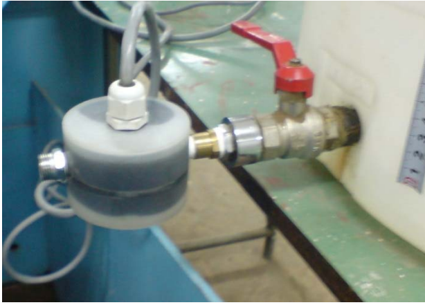
Слика 15: Мали мерач протока SI+ EM DN8 и инсталација за калибрацију мерача
