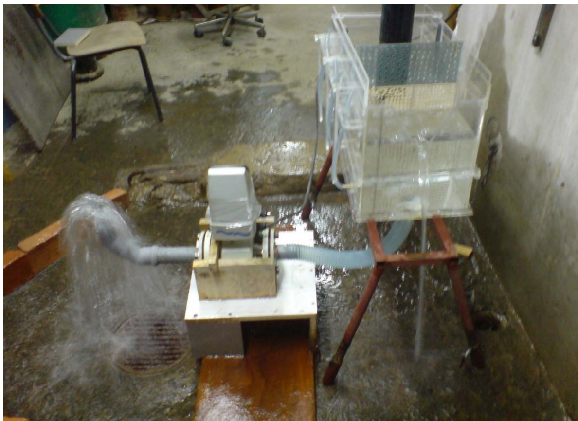
Слика 22: Мерна кутија + мерач, диспозиција 2 , калибрација прелива, проток кроз систем 1.8 l/s
