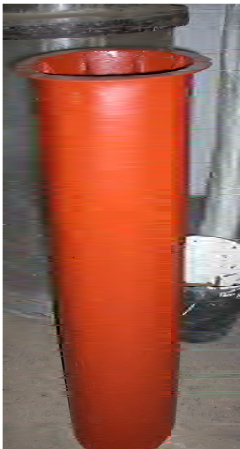
Слика 7. Плочасти мешач тока направљен као кружни уметак
