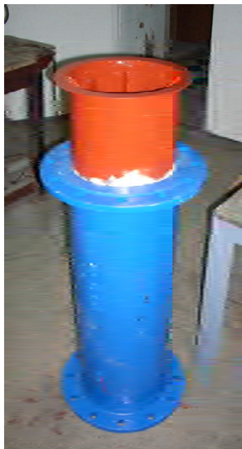
Слика 6. Кружни уметак у цеви пречника 250mm
