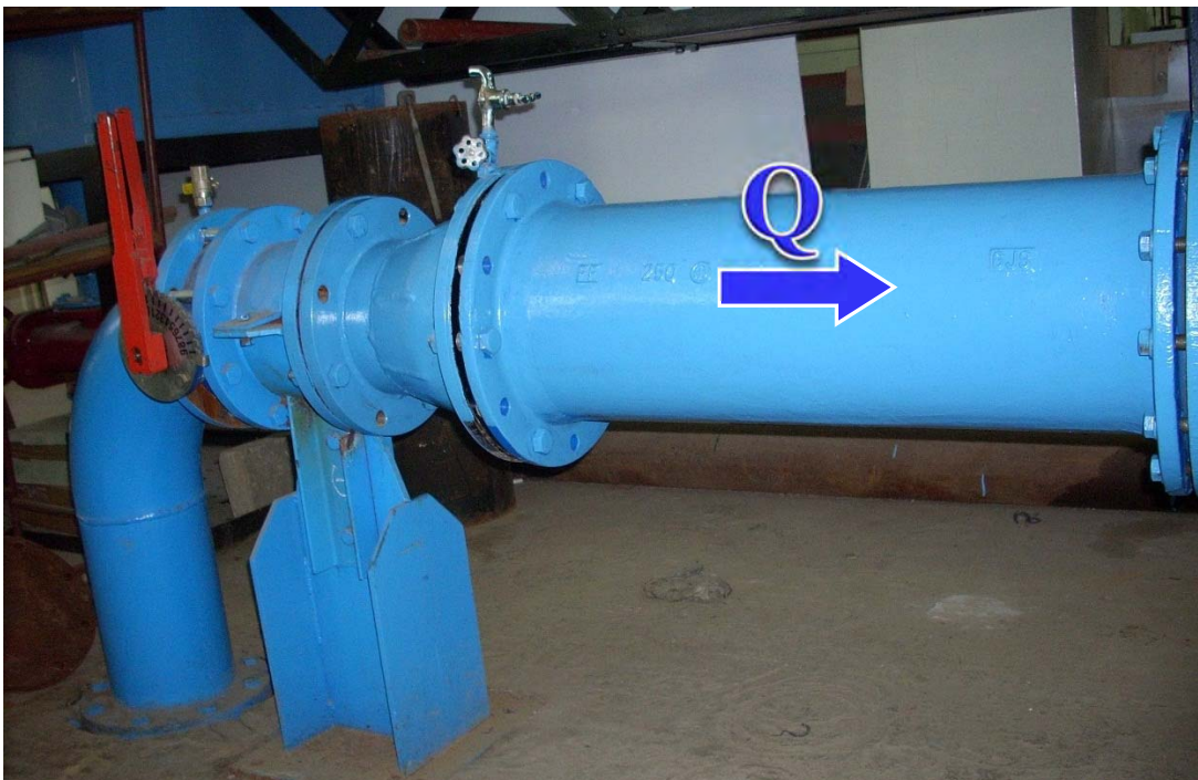
Слика 15. Узроци деформације струјне слике. Друго колено и лептирасти затварач након кога је цев у коме се смешта плочасти мешач тока
