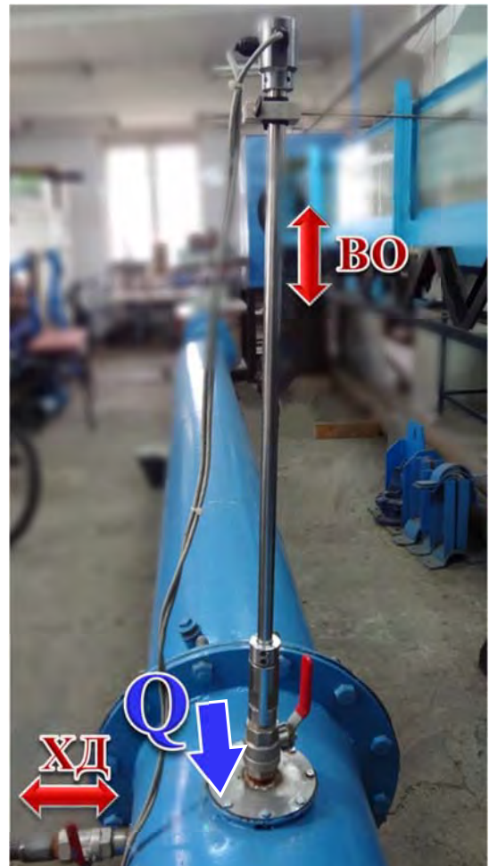
Слика 10. Електромагнетна сонда, положај у цеви вертикални одозго
