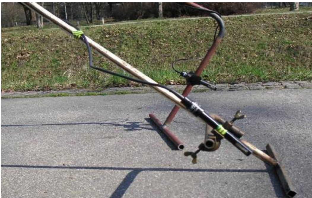
Слика 4.5: Сонде постављене на држаче
