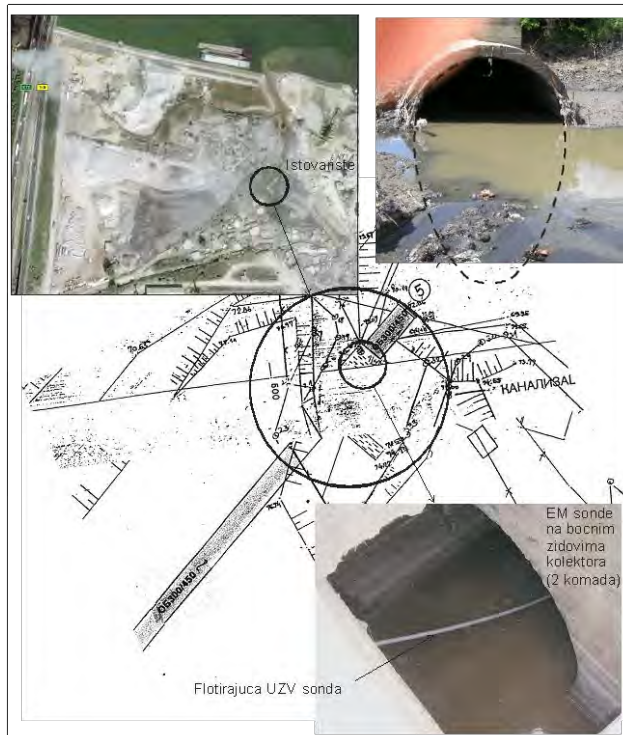
Слика 10. Локација излива код Панчевачког моста (Истовариште) са АДВ мерачем протока
