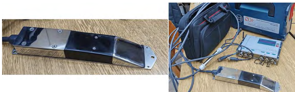
Слика 2. Пример равног ЕМ сензора за мерење брзине и дубине, са преносним логером
