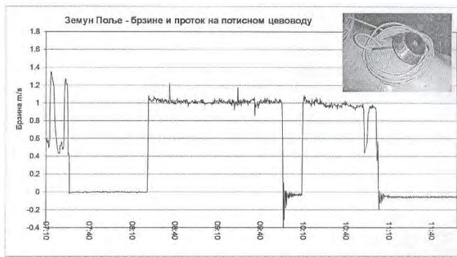
Слика 14. Кружна равна ЕМ сонда и снимљене брзине на једном од два цевовода (осредњене брзине са леве и десне сонде)
