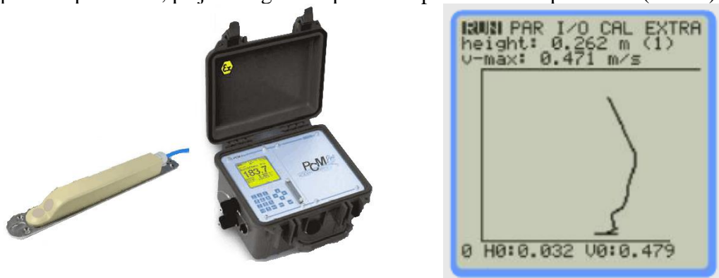
Slika 2: NIVUS korelaciona sonda i izmereni raspored brzina
