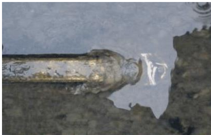
Slika 9: Realni radni uslovi UZV sonde NIVUS – nanos i kese blokiraju rad senzora
