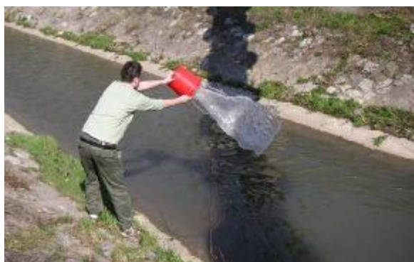
Slika 4: Merna oprema i postupak bacanja soli u vodotok
