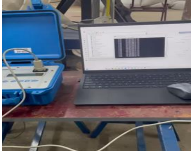
Слика 3.4. Повезана мерна јединица на рачунар
