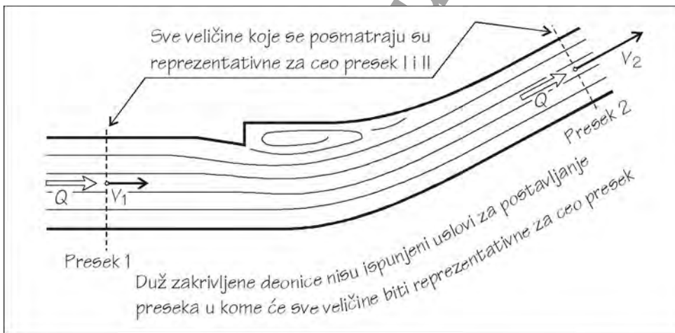
Slika 7.1: Kontrolni presek se postavlja na mestu gde su strujnice međusobno paralelne i upravne na presek
