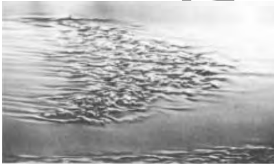
Slika 6.24: Tranzicija laminarnog u turbulentni sloj (tok je sa leva na desno) - snimak B. Cantwell, Stanford University
