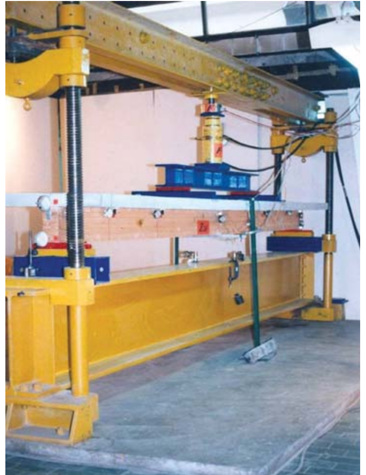
Рам са системом за аплицирање оптерећења током испитивања гредног носача
