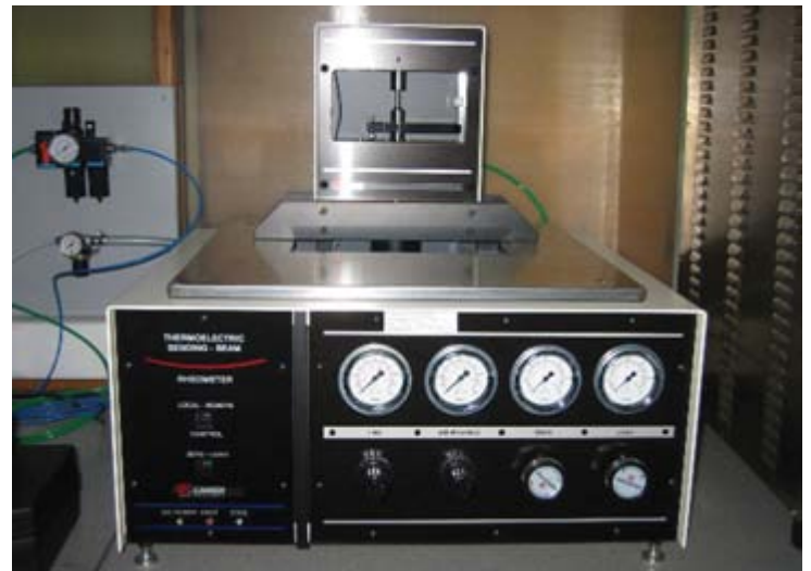
Реометар за савијање гређица ( BBR ) за испитивање отпорности битумена на ниске температуре
