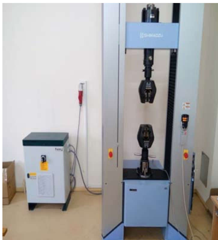
Електромеханичка кидалица Shimadzu, капацитета 300 kN (тачност 1 N)
