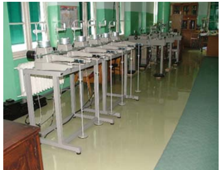
Апарат за триаксијални опит
