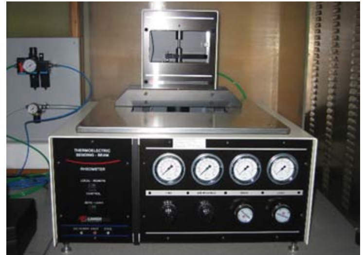
Реометар за савијање гредица ( BBR ) за испитивање отпорности битумена на ниске температуре
