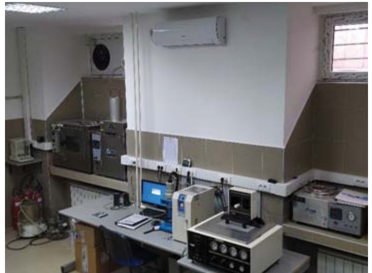
Опрема за испитивање реолошких карактеристика битумена према методологији SUPERPAVE
