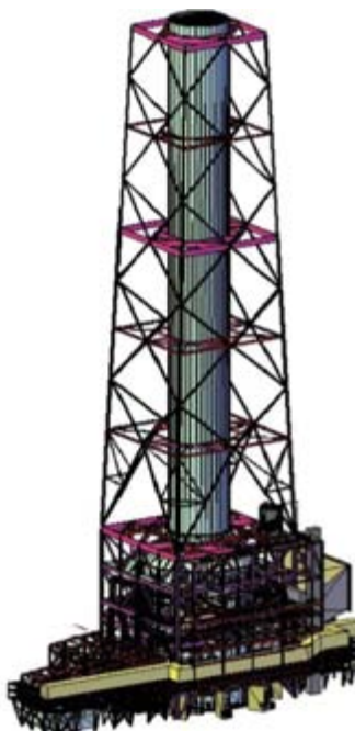
Прорачунски модели димњака, силоса за гипс и зграде млина, у оквиру Постројења за одсумпоравање димних гасова у ТЕ Никола Тесла А у Обреновцу
