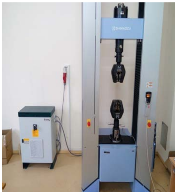
Електромеханичка кидалица Shimadzu, капацитета 300 kN (тачност 1 N)
