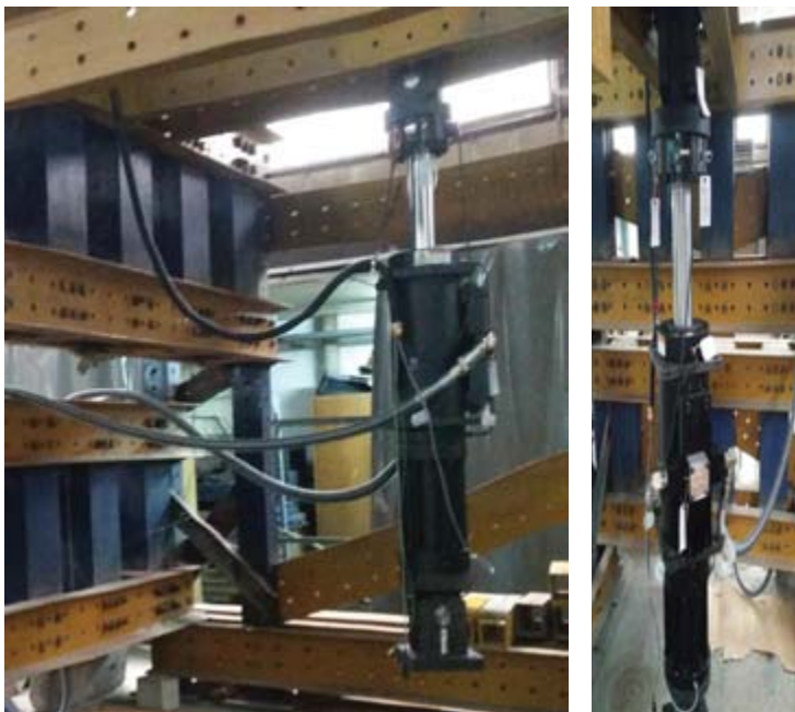
Серво електрохидраулички актуатор приликом пробног пуштања у рад
