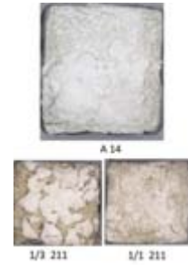
Отпорност кречних малтера на дејство растворљивих соли
