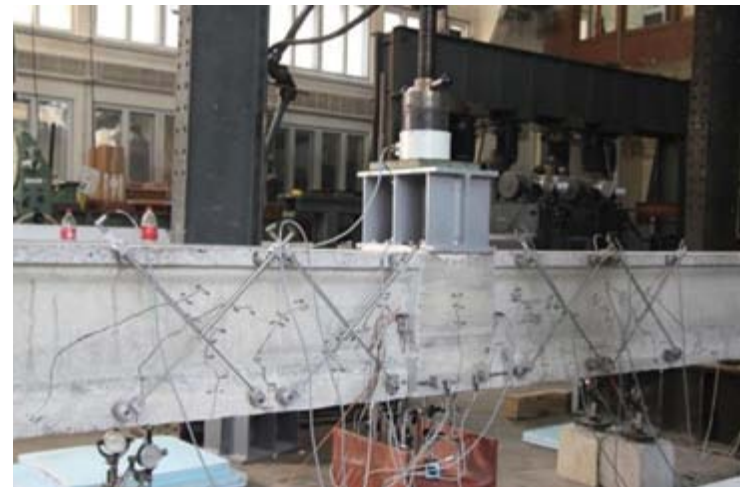
Испитивање носивости на смицање континуиране ошупљене плоче
