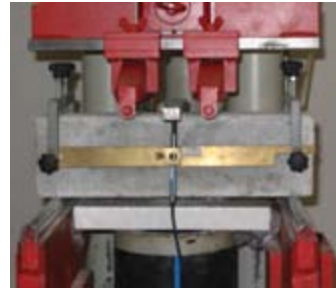
Испитивање дуктилности микроармираног бетона
