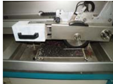
Трајна деформација асфалта са агрегатом од рециклираног бетона
