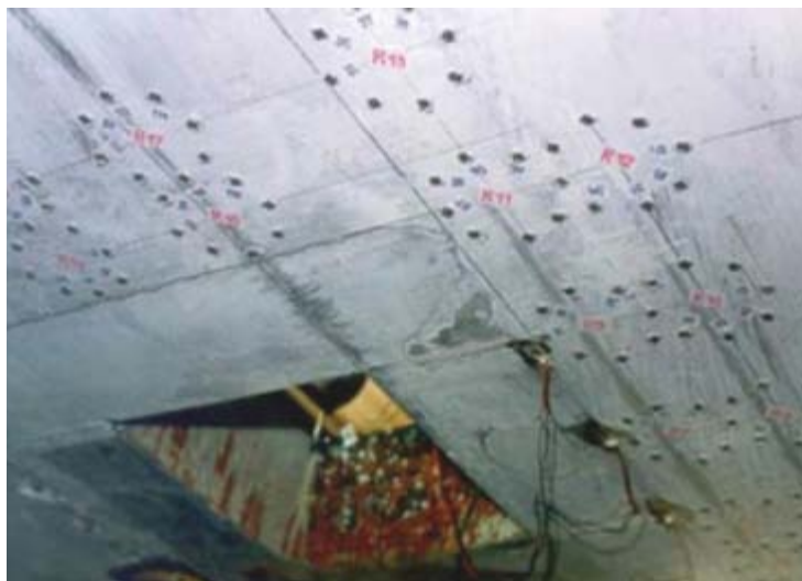
Испитивање граничне носивости при пробијању монтажних претходно напрегнутих плоча у области ивичних стубова
