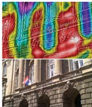
Енергетски нивои зграде (лево); снимак зграде помоћу термовизијске камере (десно)
