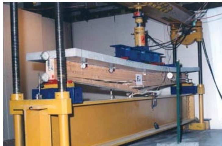
Испитивање спрегнутих носача дрво-бетон при статичком и динамичком оптерећењу
