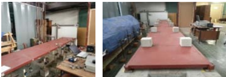
Испитивање конструкцијског модела за потребе детекције оштећења
