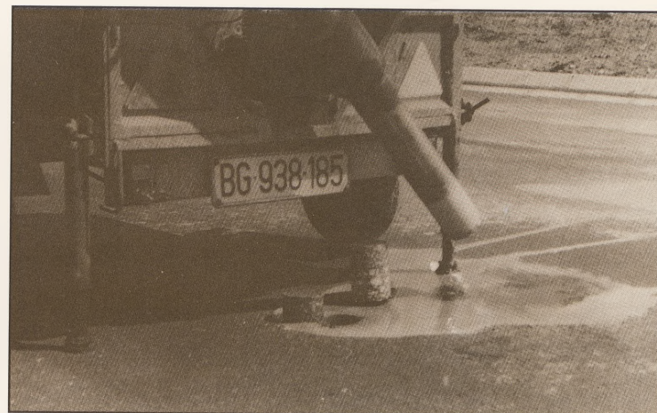
Слика 21 – Вађење узорка из коловозне конструкције
