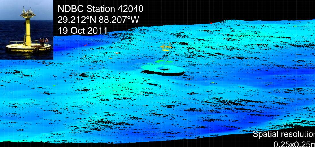
Primer topografije okeana, izmerena pomoću MASS sistema tokom eksperimenta u Meksičkom zalivu, iznad NDBC buove #42040.
