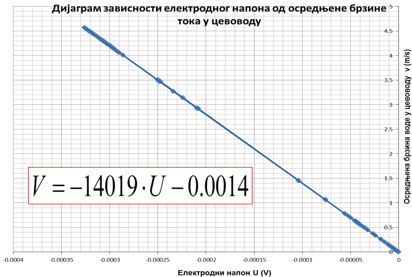
Слика 16. Калибрациони дијаграм зависности осредњене брзине тока од електродног напона
