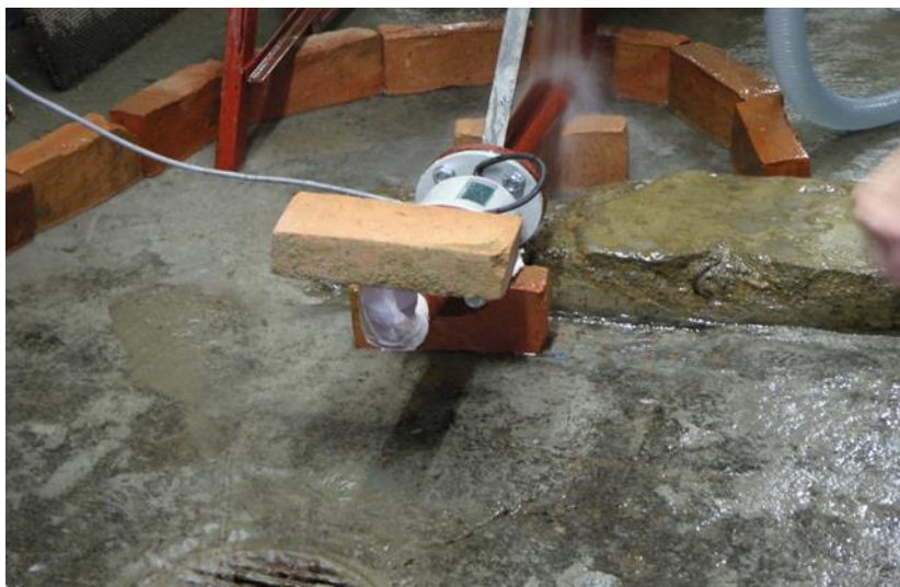
Слика25: Затварање дела апаратуре (проток кроз доњи мерач једнак је нули)
