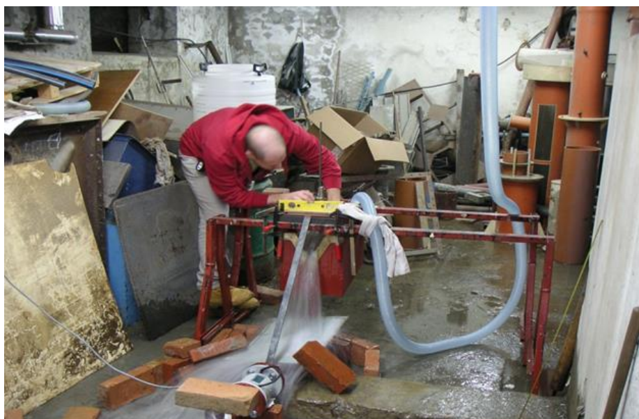
Слика26: Мерње висине преливног млаза помоћу мерне игле
