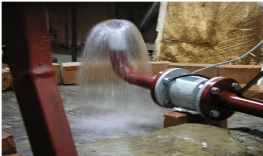
Слика30: Обезбеђен проток кроз цев преко доњег мерила
