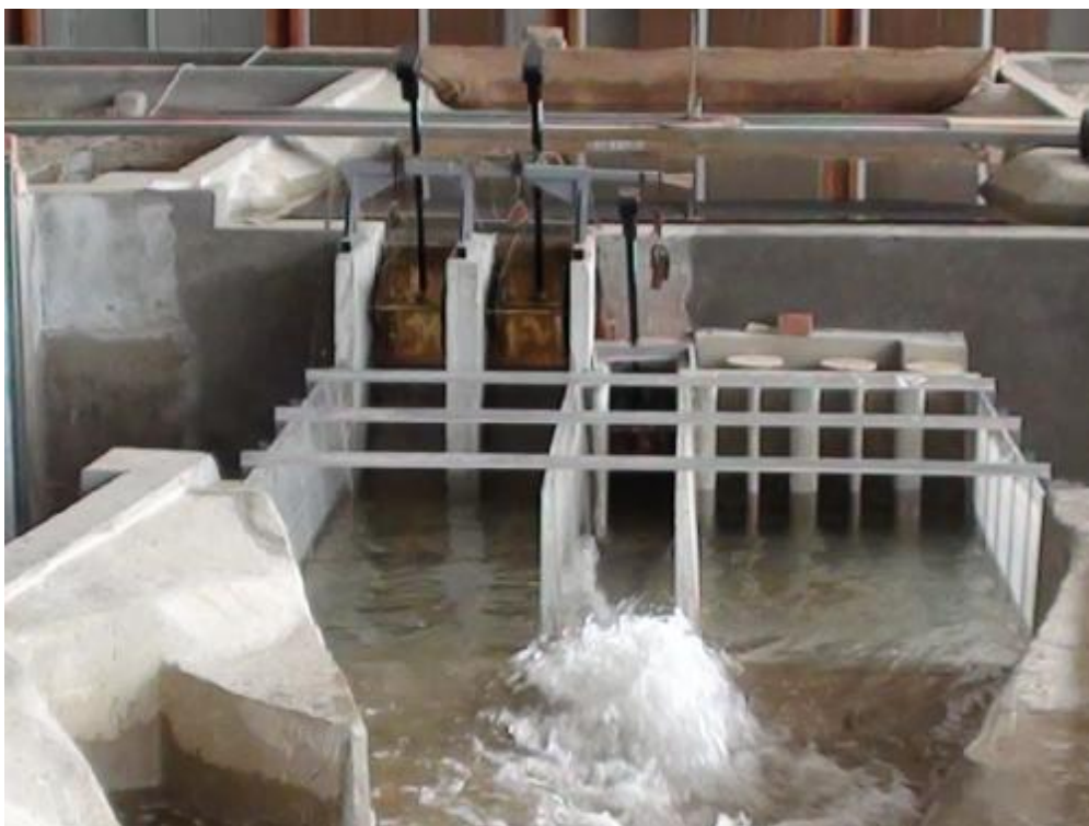
Слика 3. Физички модел бране и ХЕ „Бук Бијела“ у размери 1:45, слапиште (поглед узводно)
