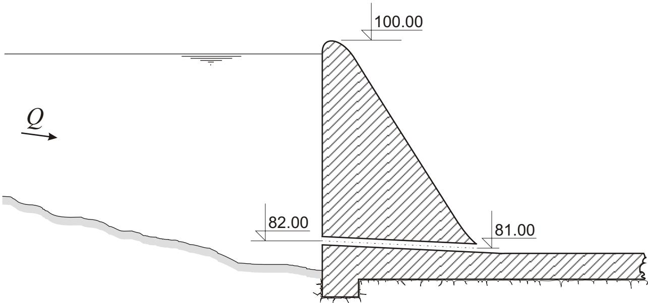
За стварање акумулационог језера на неком водотоку пројектована је бетонска брана са преливом и слапиштем.
