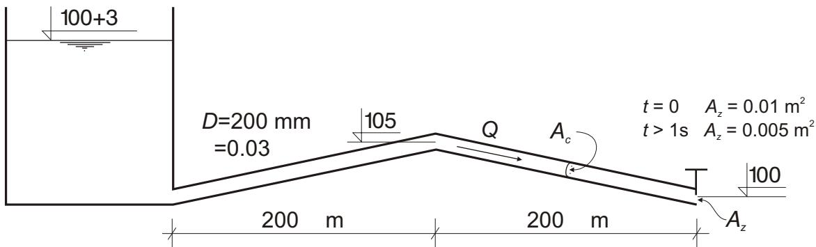
Из резервоара вода истиче кроз цев кружног попречног пресека на чијем се крају налази затварач. Пречник цеви је  $D=200$  mm, а коефицијент трења  $=0.03$ . Површина отвора затварача је у почетном тренутку, када је затварач потпуно отворен,  $A_z=0.01\text{ m}^2$ .
