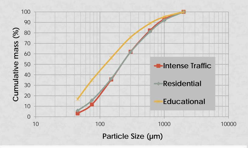
PARTICLE SIZE DISTRIBUTION VERSUS GRAIN SIZE FRACTION FOR RDS
