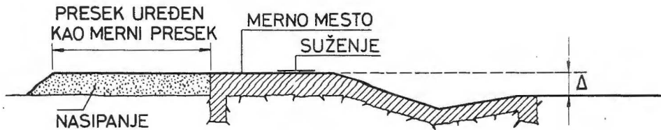
Slika 7. Postizanje potrebnog spuštanja dna za merni objekat koji se naknadno ugrađuje u kanal.
