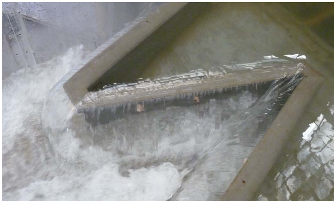
Hidraulički model lavirint preлива u Institutu za vodoprivredu „Jaroslav Černi“. Foto: R. Kapor
