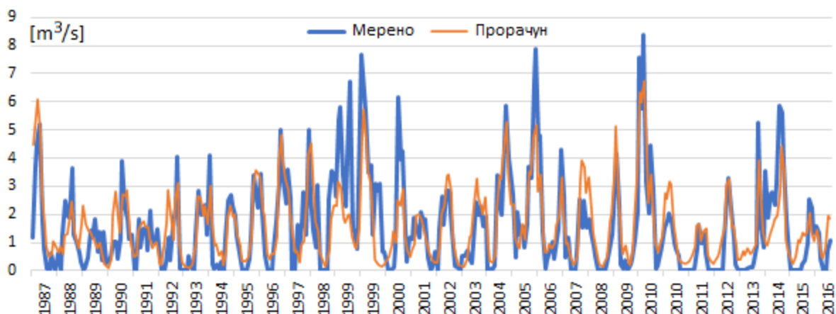
Slika 10. Poređenje sumarnog protoka na svih sedam pumpnih stanica
