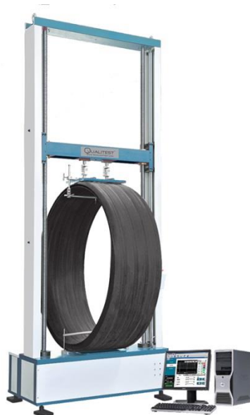
Slika 10. Izgled aparature za testiranja obodne krutosti SN
