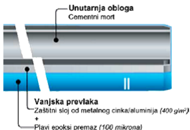
Slika 5. Tipični strukturni presek duktilne gvozdene cevi
