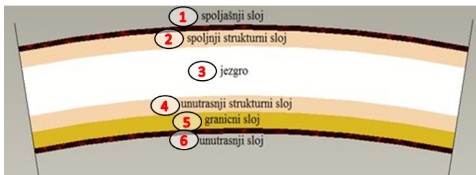
Slika 1. Tipični strukturni presek GRP cevi
